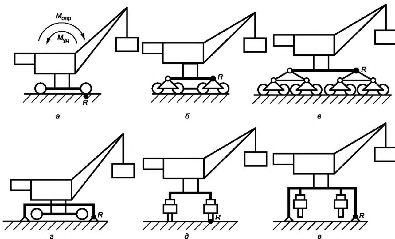
Примечание – Знак «●» показывает положение ребра опрокидывания.
