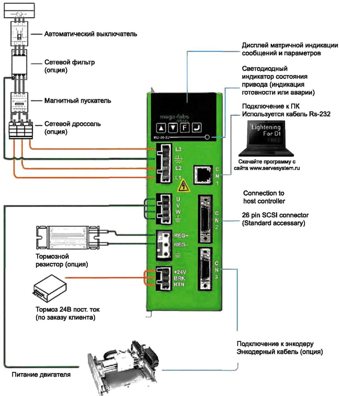
Рисунок 9 — Состав и функции системы компании СК «Станкоснаб»
