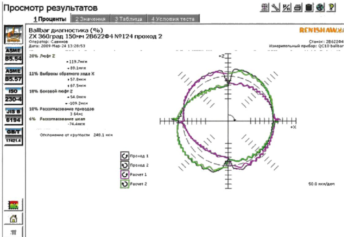
Рисунок Д.5 — Результаты проверки точности и постоянства обработки круговой траектории на станке 2B622Ф4 в плоскости X и Z по методике Renishaw
