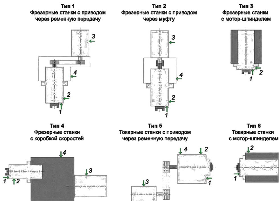
Рисунок В.7 — Типовые схемы установки датчиков по типам привода
