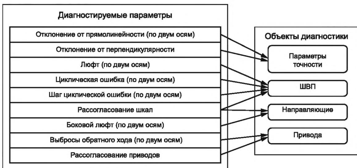
Рисунок А.2 — Диагностируемые параметры и объекты диагностики
