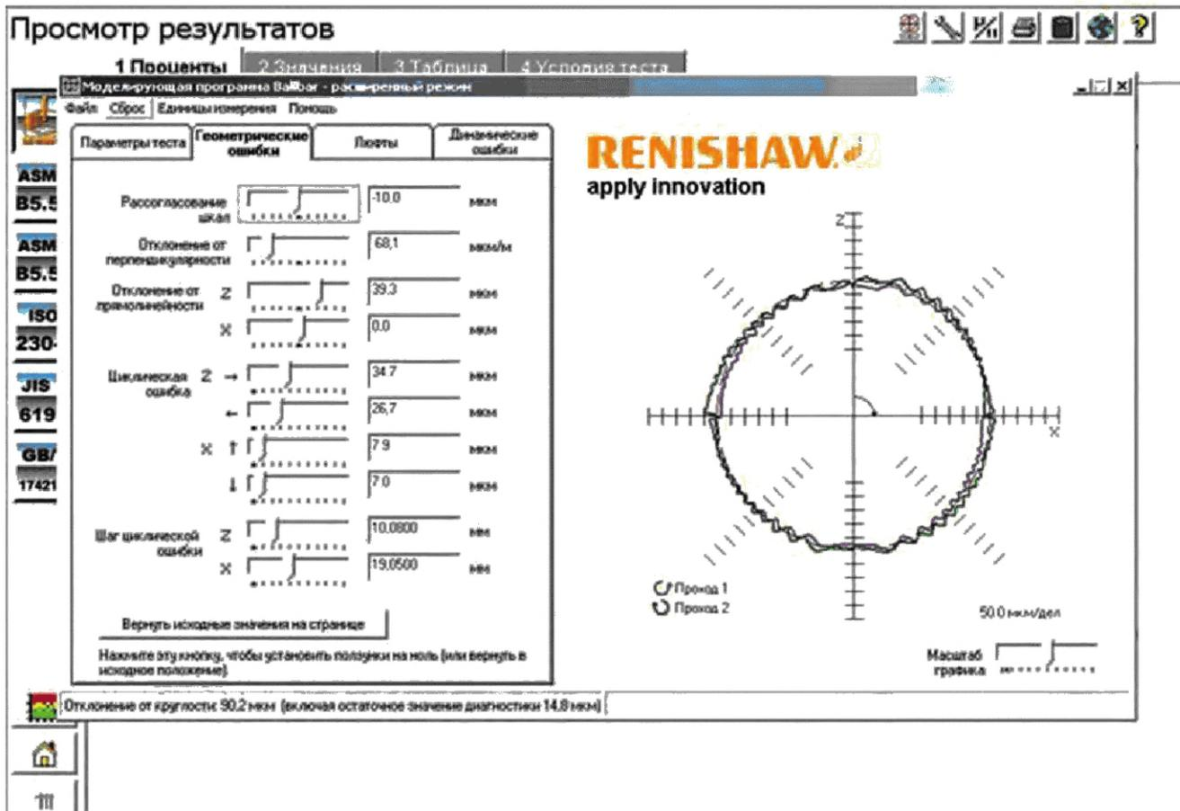
Рисунок Д.8 — Результаты модуляции проверки точности и постоянства отработки круговой траектории на станке 2В622Ф4 в плоскости X и Z по методике Renishaw при устранении вышеприведенных недостатков
