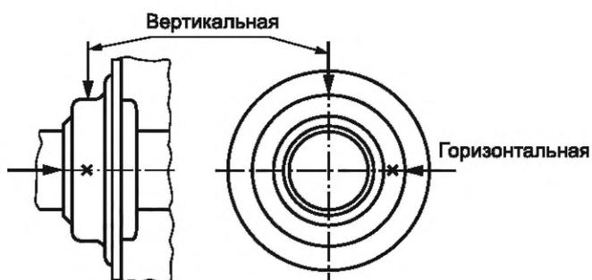
Рисунок В.2 — Точки измерения на корпусе подшипника
