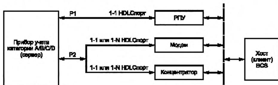
P1 — оптический порт — для локального доступа; P2 — RS-232/RS-485-порт — для удаленного доступа
