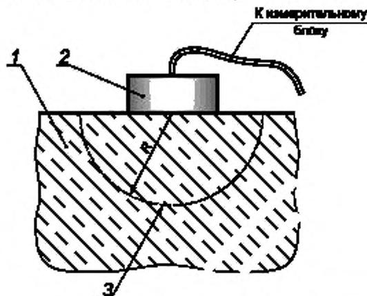
1 — контролируемый материал; 2 — поверхностный датчик; 3 — зона действия высокочастотного поля датчика,
