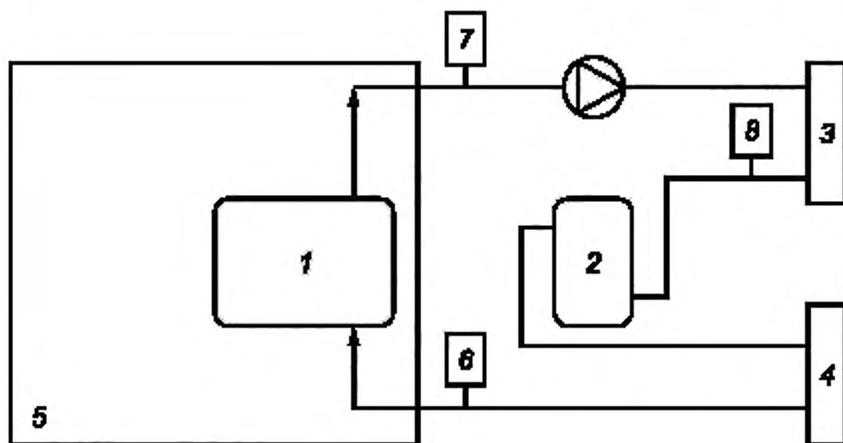
1 — испытуемый прибор; 2 — резервуар; 3 — первичный компенсационный теплообменник; 4 — вторичный компенсационный теплообменник; 5 — климатическая испытательная комната; 6 — температура на входе во внутренний теплообменник прибора; 7 — температура на выходе внутреннего теплообменника прибора; 8 — промежуточная температура для контроля испытательной установки (менее температур 6 и 7)
