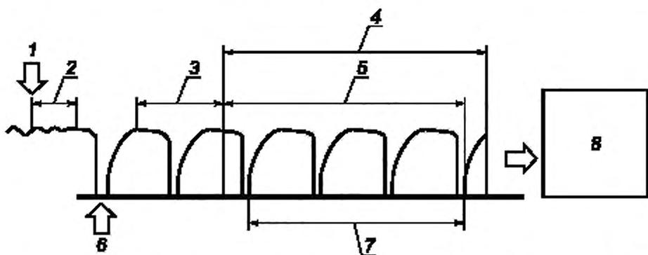
1 — соблюдение первых допусков; 2 — период предварительной подготовки (минимум 10 мин); 3 — период равновесия 30 мин; 4 — период сбора данных 3 ч; 5 — период сбора данных; 6 — размораживание в конце периода подготовки; 7 — три полных цикла данных для расчета мощности; 8 — временное испытание (прекращают испытание, когда период сбора данных равен 3 ч)
