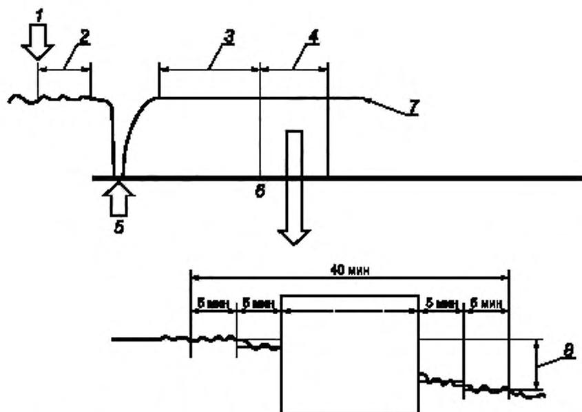
1 — наблюдение первых допустимых отклонений; 2 — период предварительной подготовки (минимум 10 мин); 3 — период равновесия 30 мин; 4 — данные для расчета мощности (период сбора данных 40 мин); 5 — размораживание в конце периода подготовки; 6 — данные (позиции 4) расширены для детализации; 7 —  $\Delta T_{water}$  (внутренняя сторона); 8 —  $\Delta T$  уменьшается на 2,5 % или менее в течение первых 40 мин периода сбора данных
