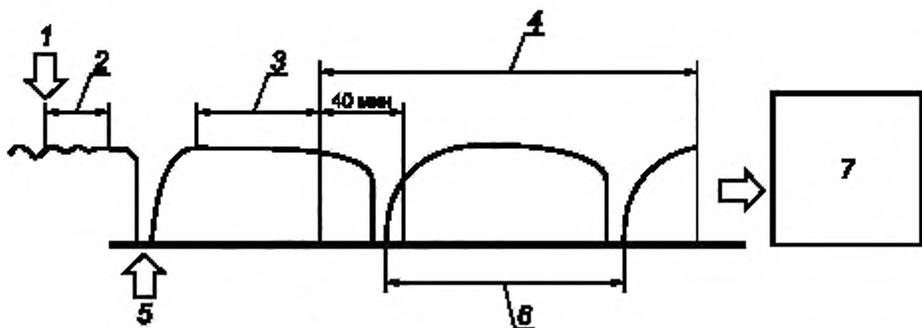
1 — соблюдение первых допустимых отклонений, 2 — период предварительной подготовки (минимум 10 мин), 3 — период равновесия 30 мин; 4 — период сбора данных 3 ч, 5 — размораживание в конце периода подготовки; 6 — один полный цикл данных для расчета мощности; 7 — временное испытание (прекращают испытание, когда период сбора данных равен 3 ч)
