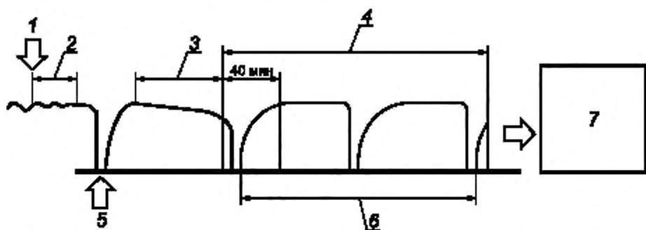
1 — соблюдение первых допустимых отклонений, 2 — период предварительной подготовки (минимум 10 мин), 3 — период равновесия 30 мин; 4 — период сбора данных 3 ч, 5 — размораживание в конце периода подготовки; 6 — два полных цикла данных для расчета мощности; 7 — временное испытание (прекращают испытание, когда период сбора данных равен 3 ч)
