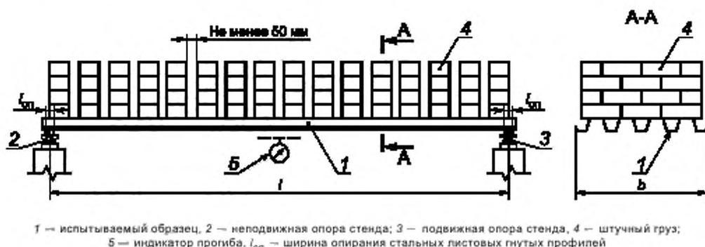
1 — испытываемый образец, 2 — неподвижная опора стэнда; 3 — подвижная опора стэнда, 4 — штучный груз;
