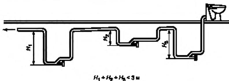
Рисунок 5 — Пример прокладки трубопроводов вакуумной сточной системы
