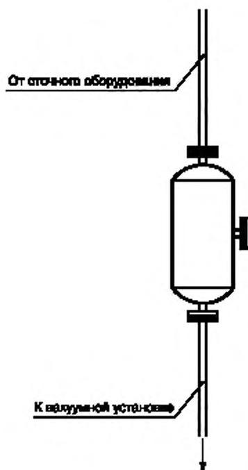
Рисунок 3 — Вакуумная емкость
