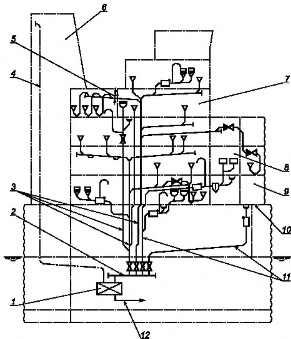
1 — вакуумная установка со сборной цистерной; 2 — главный коллектор; 3 — трубопровод сточных вод; 4 — воздушная труба;
