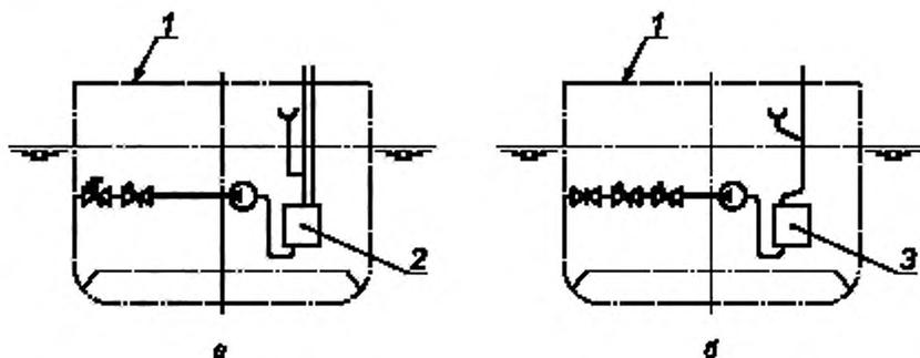
а — отливной трубопровод от установки для обработки сточных вод; б — отливной трубопровод от сборной цистерны
