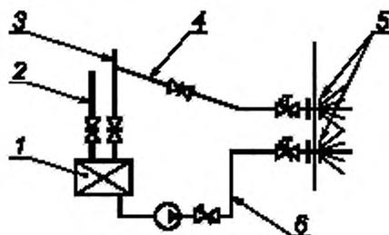
1 — оборудование для сбора сточных вод; 2 — трубопровод сточных вод; 3 — трубопровод хозяйственно-бытовых вод;
