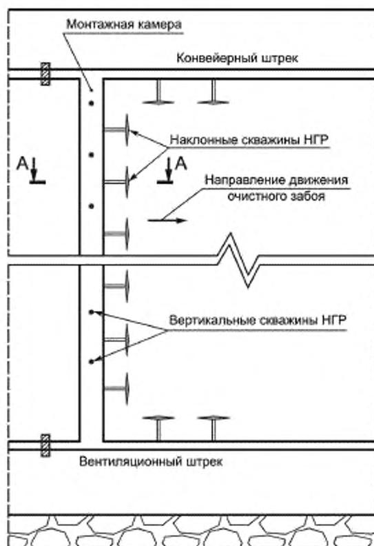
Рисунок 2 — Схема предварительного разупрочнения кровли пласта методом НГР для снижения первичного шага обрушения пород основной кровли
