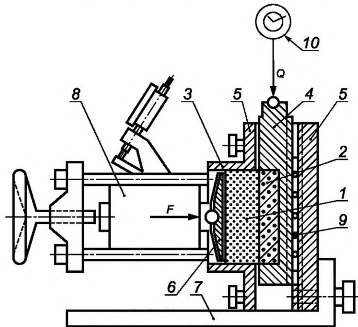
1 — мерзлый грунт; 2 — материал; 3 — рабочее кольцо; 4 — срезная каретка; 5 — корпус прибора; 6 — боковой штамп;
