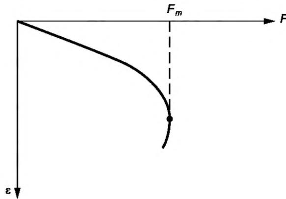
$F_m$  — максимальная нагрузка при разрушении;  $\varepsilon$  — относительная деформация;  $F$  — нагрузка
