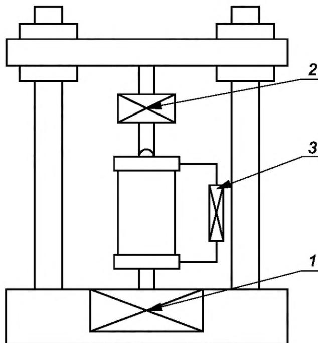
1 — механизм для вертикального нагружения образца; 2 — устройство для измерения вертикальной нагрузки на образец;
