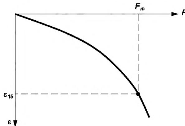
$F_m$  — максимальная нагрузка при разрушении;  $\varepsilon$  — относительная деформация;  $F$  — нагрузка;  $\varepsilon_{15}$  — деформация, соответствующая 15 % от вертикальной деформации образца
