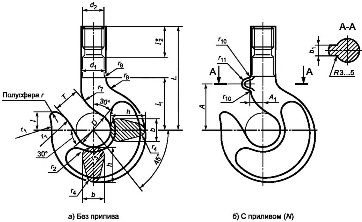
Рисунок 1 — Заготовки однорогих крюков категории I
