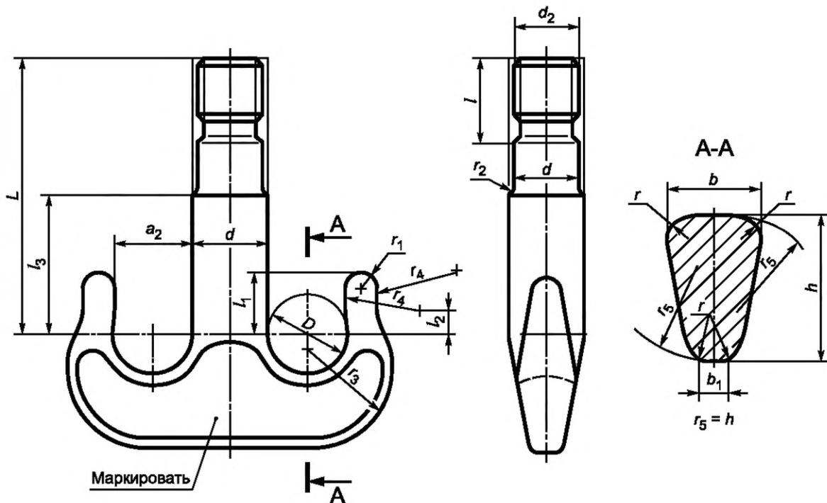
Рисунок 2 — Заготовки двурогих крюков категории II
