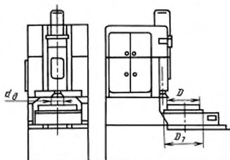
$D$  — наибольший диаметр обрабатываемого колеса,  $D_1$  — диаметр рабочей поверхности стола (фланца шпинделя изделия) по ГОСТ 1574,  $d_d$  — наибольший номинальный делительный диаметр долбяка по ГОСТ 9323 и ГОСТ 10059
