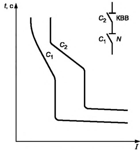
$C_1$  — нетокоограничивающий выключатель (N) (характеристика времени отключения);  $C_2$  — выключатель с преднамеренной кратковременной выдержкой времени (КВВ) (характеристика срабатывания);  $t$  — время;  $I$  — ток
