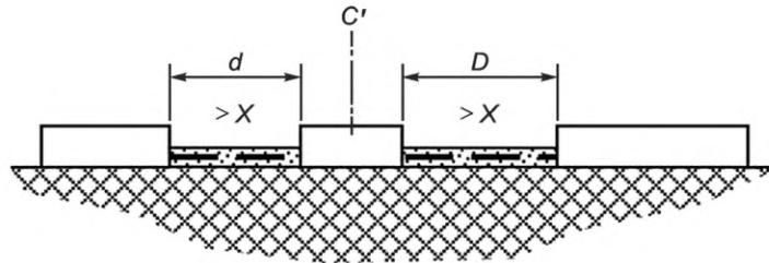
$C'$  — свободно движущаяся часть;  $d + D$  — воздушный зазор;  $d + D$  — расстояние утечки;
