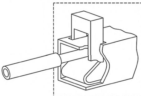
Безвинтовой вывод с зажимом через промежуточный элемент
