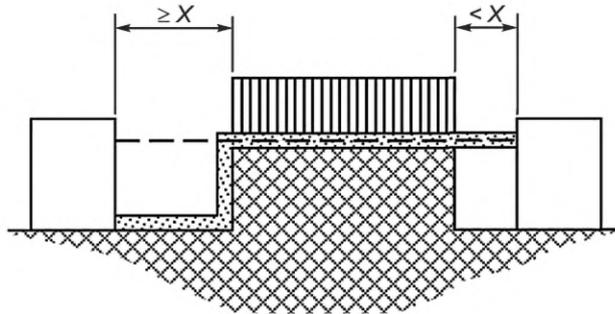
Условие: Этот путь охватывает нескрепленный стык с желобком шириной менее  $X$  мм с одной стороны и равный или более  $X$  мм — с другой стороны.
