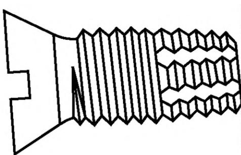
Рисунок 2 — Самонарезающий режущий винт (см. 3.3.23)
