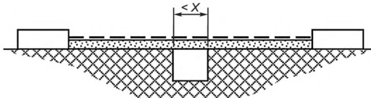
Условие: Рассматриваемый путь утечки охватывает желобок с параллельными или сходящимися боковыми стенками любой глубины при ширине менее  $X$  мм.
