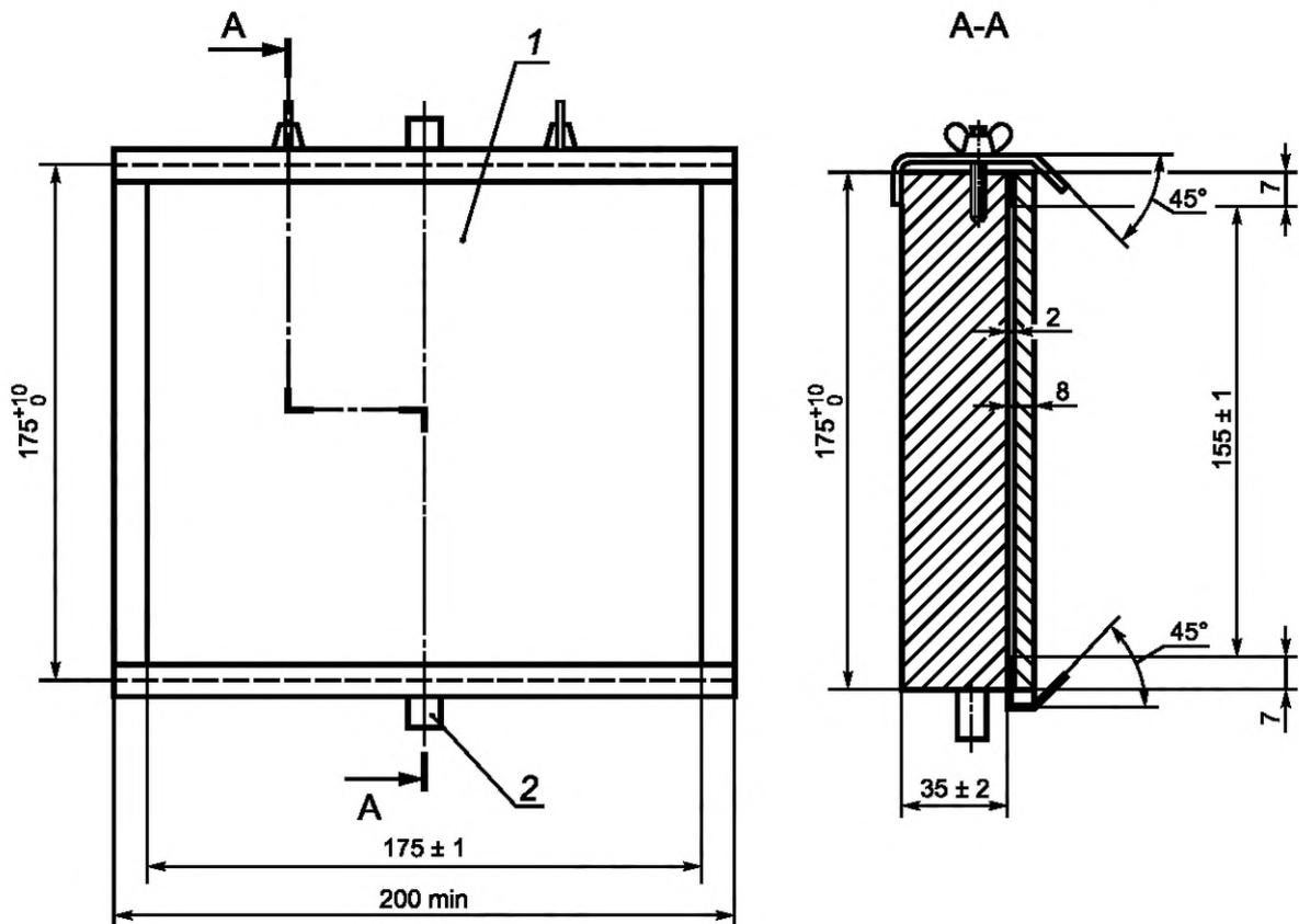
1 — монтажная опора из древесины; 2 — стержень для поворота вокруг вертикальной оси
