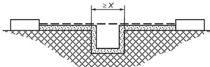
Условие: Рассматриваемый путь охватывает желобок с параллельными боковыми стенками любой глубины шириной  $X$  мм или более.
