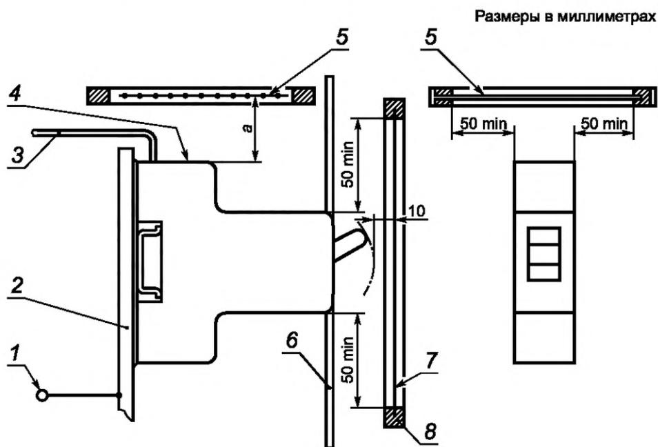
1 — к предохранителю *F*; 2 — металлическая панель; 3 — кабель; 4 — выхлопное окно;
