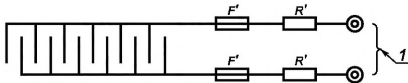
1 — присоединение к точкам В и С;  $F'$  — плавкий предохранитель;  $R'$  — резистор
