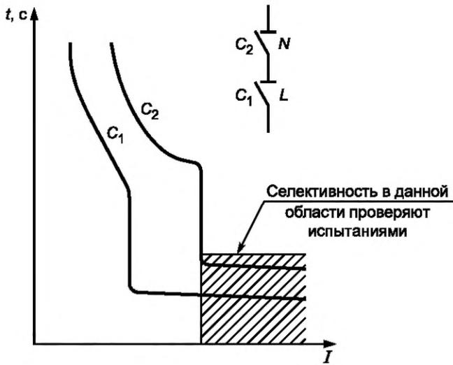
$C_1$  — токоограничивающий выключатель (L) (характеристика времени отключения);
