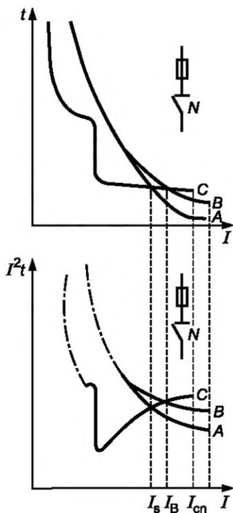
$I$  — ожидаемый ток короткого замыкания;  $I_{cn}$  — номинальная предельная наибольшая отключающая способность (5.2.4);  $I_s$  — предельный ток селективности (3.5.14.6);  $I_B$  — ток координации (3.5.14.7);  $A$  — преддуговая характеристика плавкого предохранителя;  $B$  — рабочая характеристика плавкого предохранителя;  $C$  — рабочая характеристика нетокоограничивающего выключателя ( $N$ ) (время отключения/ток и  $I^2t$ /ток);  $t$  — время
