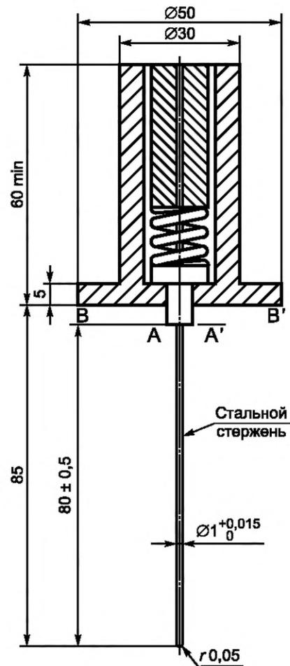
При калибровке прибора силу 1 Н прикладывают к наконечнику жесткого стального стержня вдоль его оси до совмещения плоскостей A-A' и B-B' за счет сжатия внутренней пружины.
