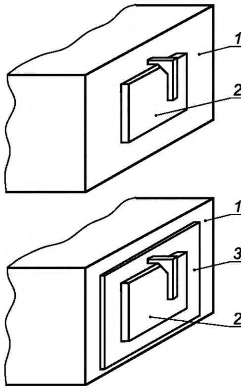
1 — монтажная поверхность; 2 — розетка; 3 — опорная поверхность; 4 — расположение детали, имеющей ту же толщину, что и опорная часть
