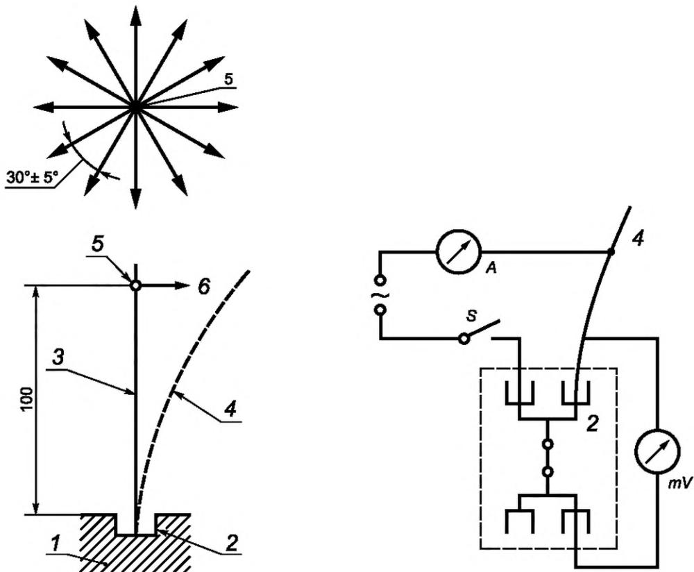
а) принцип действия испытательной установки для проверки на изгиб безвинтовых контактных зажимов
