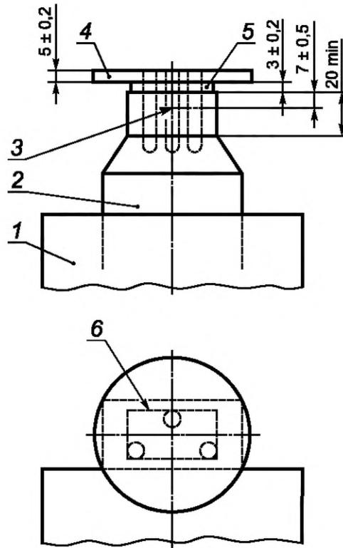
1 — нагревательный элемент; 2 — металлическая часть В; 3 — термопара; 4 — изолирующая плита А; 5 — прокладка;
