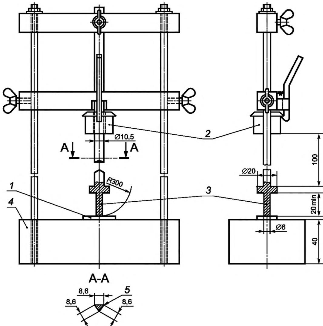
1 — образец; 2 — груз массой  $(100 \pm 1)$  г; 3 — промежуточная стальная вставка массой 100 г; 4 — стальная опора массой  $(10 \pm 1)$  кг; 5 — края закруглить
