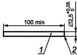
1 — испытательный металлический стержень; 2 — края стержня прямоугольной формы
