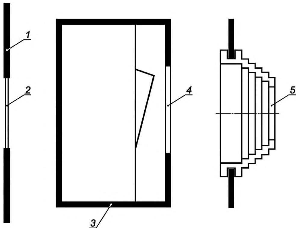
1 — оболочка; 2 — входная мембрана; 3 — конверт; 4 — защитная мембрана; 5 — кабельный ввод
