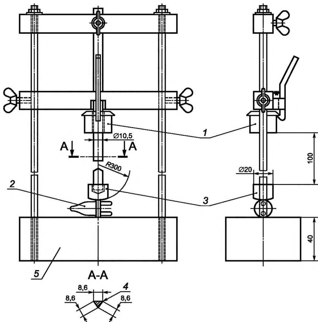
1 — боек массой  $(1000 \pm 2)$  г; 2 — образец; 3 — прижим массой 100 г; 4 — края закруглить; 5 — стальная опора  $(10 \pm 1)$  кг
