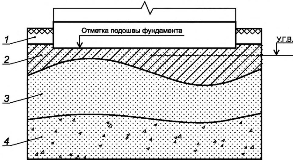
1 — насыпной грунт, 2 — суглинок, 3 — песок, 4 — песок средней крупности с включением гравия
