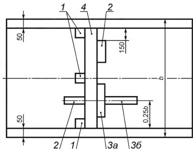
$b$  — ширина проката; 1, 2, 4 — образцы; 3а, 3б — заготовки
