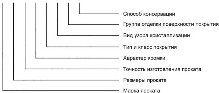
Прокат марки 01 в листах толщиной 1,00 мм, шириной 1000 мм, длиной 2000 мм, нормальной точности изготовления категории Б, с необрезной кромкой НО, с цинковым покрытием Ц класса 275, с нормальным узором кристаллизации цинка вида Н, группы отделки поверхности покрытия обычного качества, промасленный ПР, по ГОСТ 14918—2020:
