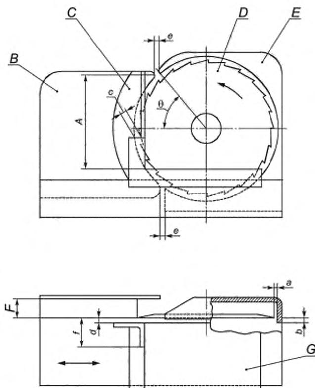
A — общая высота открытой секции; B — пластина, которая устанавливает толщину нарезки кусочков; C — защита большого пальца руки; D — вращающееся лезвие; E — защита лезвия; F — толщина нарезки кусочков; G — подвижный стол подачи
