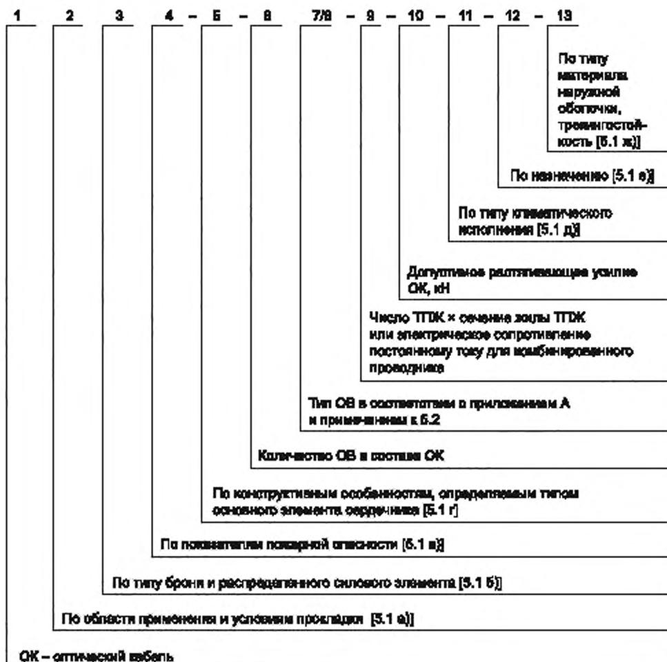
Рисунок 1 — Структура условного (кодového) обозначения оптического кабеля
