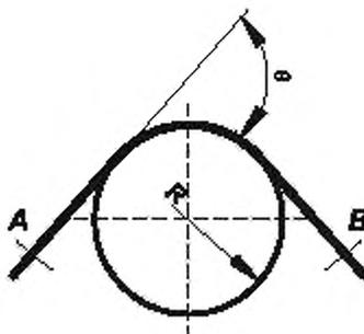
Рисунок 11 — Схема испытания ОК на перемотку через ролик
