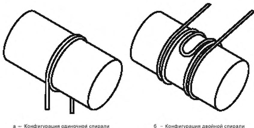
Рисунок 15 — Схема испытания ОК на воздействие статического изгиба
