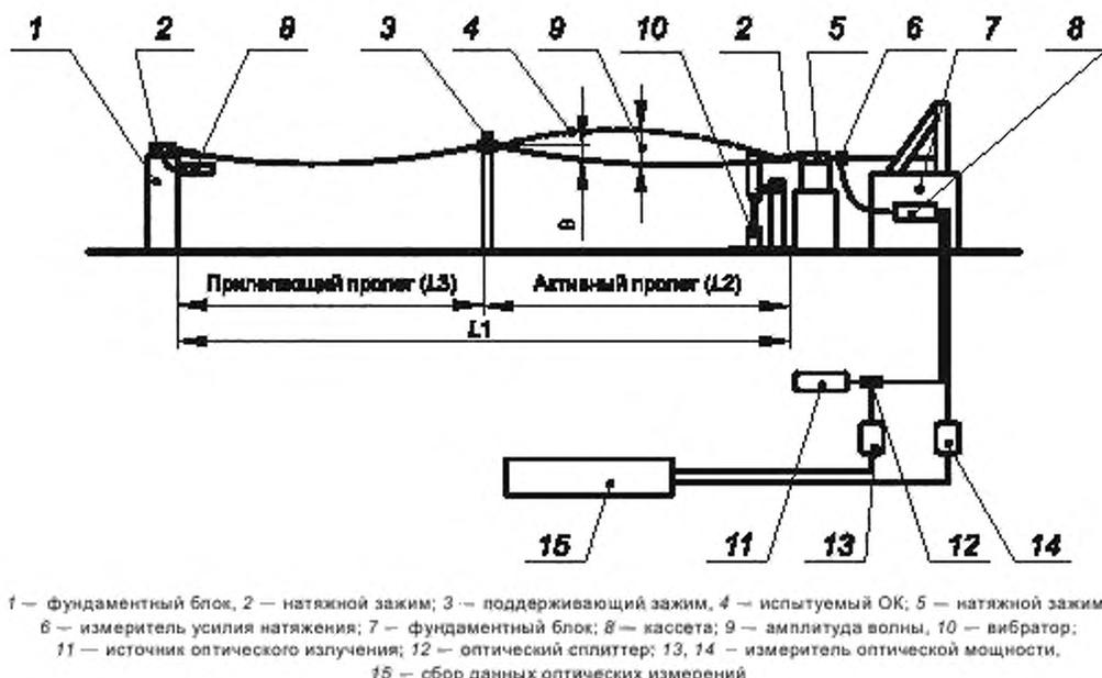
Рисунок 10 — Схема испытания ОК на воздействие галопирования
