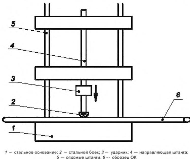
Рисунок 5 — Схема испытания ОК на воздействие удара
