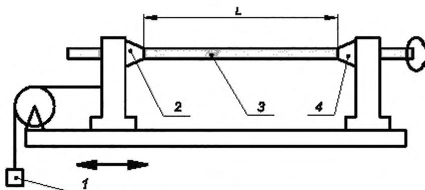
1 — натяжной груз; 2 — фиксированный зажим ОК; 3 — образец ОК; 4 — вращаемый зажим ОК;
