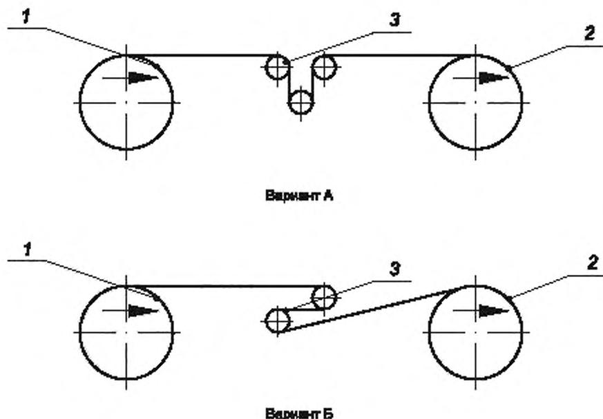
1 -- отдающее устройство; 2 -- приемное устройство; 3 -- ролики
