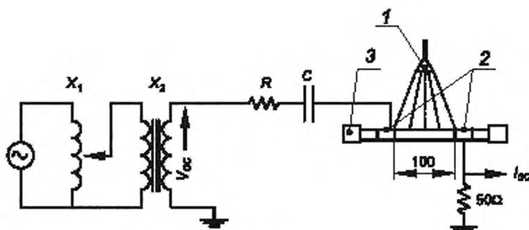
1 — распылитель солевого раствора; 2 — электроды из фольги; 3 — герметизированные концы ОК;  $X_1$  — автотрансформатор;  $X_2$  — высоковольтный трансформатор;  $V_{oc}$  — напряжение на высоковольтной обмотке;  $I_{oc}$  — ток при возникновении разрядов;  $R, C$  — ограничители тока нагрузки
