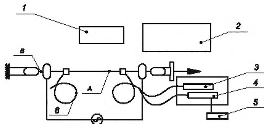
1 — датчик для измерения температуры несущего провода; 2 — устройство регистрации температуры;
