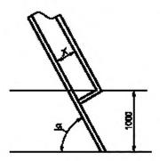
Рисунок 5 — Расположение поручней на лестнице с углом наклона от 55° до 75°
