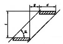
Рисунок 1 — Геометрические параметры маршевых лестниц
