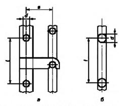
Рисунок 3 — Геометрические параметры отдельных (a) и интегрированных (б) вертикальных лестниц
