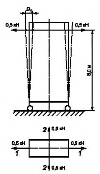
1 — первое испытание в двух противоположных направлениях; 2 — второе испытание в двух противоположных направлениях
