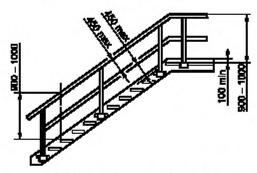
Рисунок 4 — Геометрические параметры защитного ограждения маршевой лестницы
