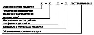
Пример условного обозначения подмостей сборно-разборных из плоских секций, с нормативно распределенной нагрузкой 2 кН/м<sup>2</sup>, максимальной высотой рабочей платформы подмостей 10,0 м, типа доступа к платформам в виде наклонных лестниц, соответствующих настоящему стандарту:
