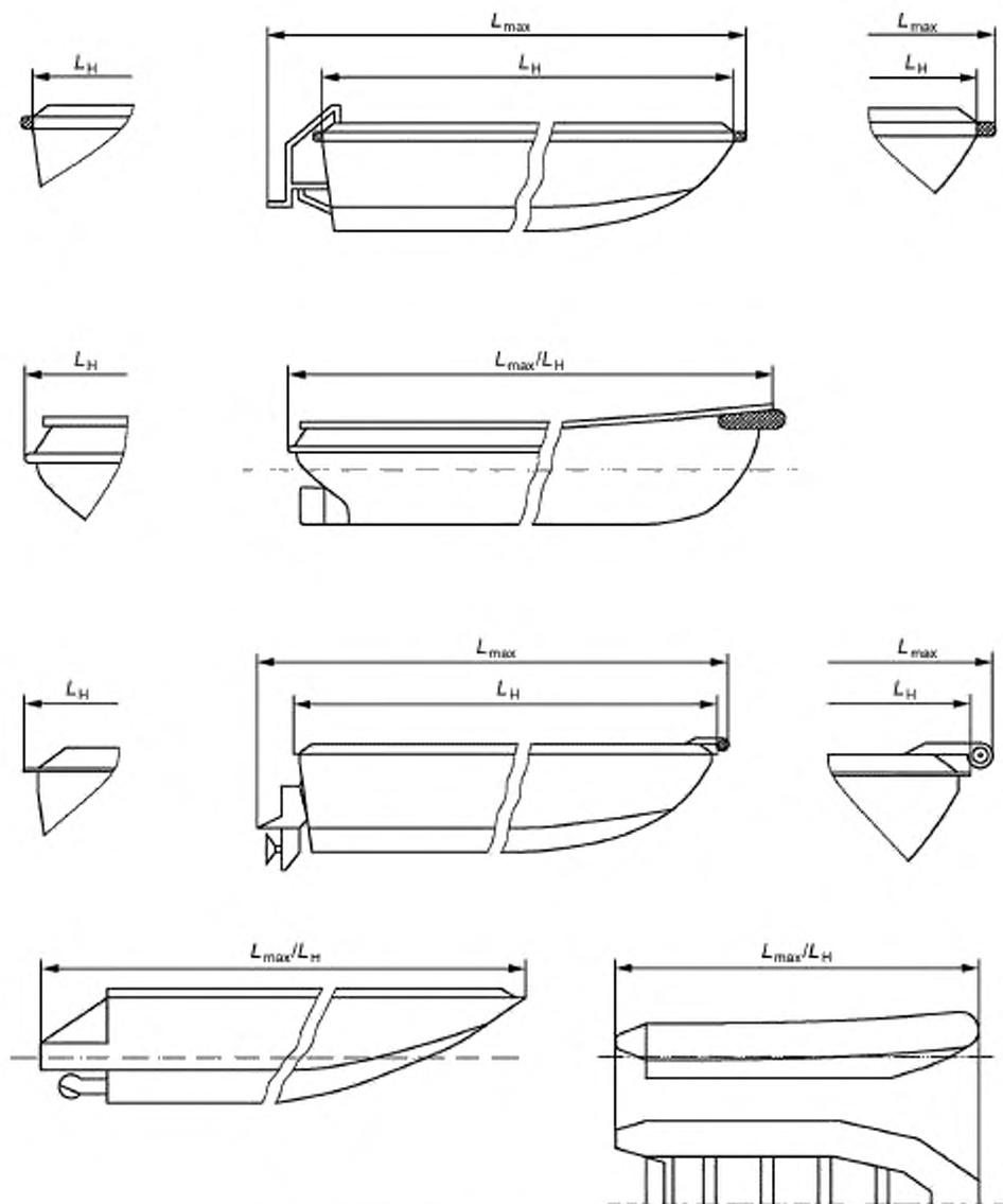
а) Определение  $L_{max}$  и  $L_H$  для непарусных судовРисунок 1 — Определение  $L_{max}$  и  $L_H$  для однокорпусных судов
