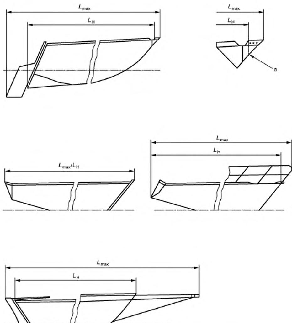
б) Определение  $L_{max}$  и  $L_H$  для однокорпусных парусных судов
