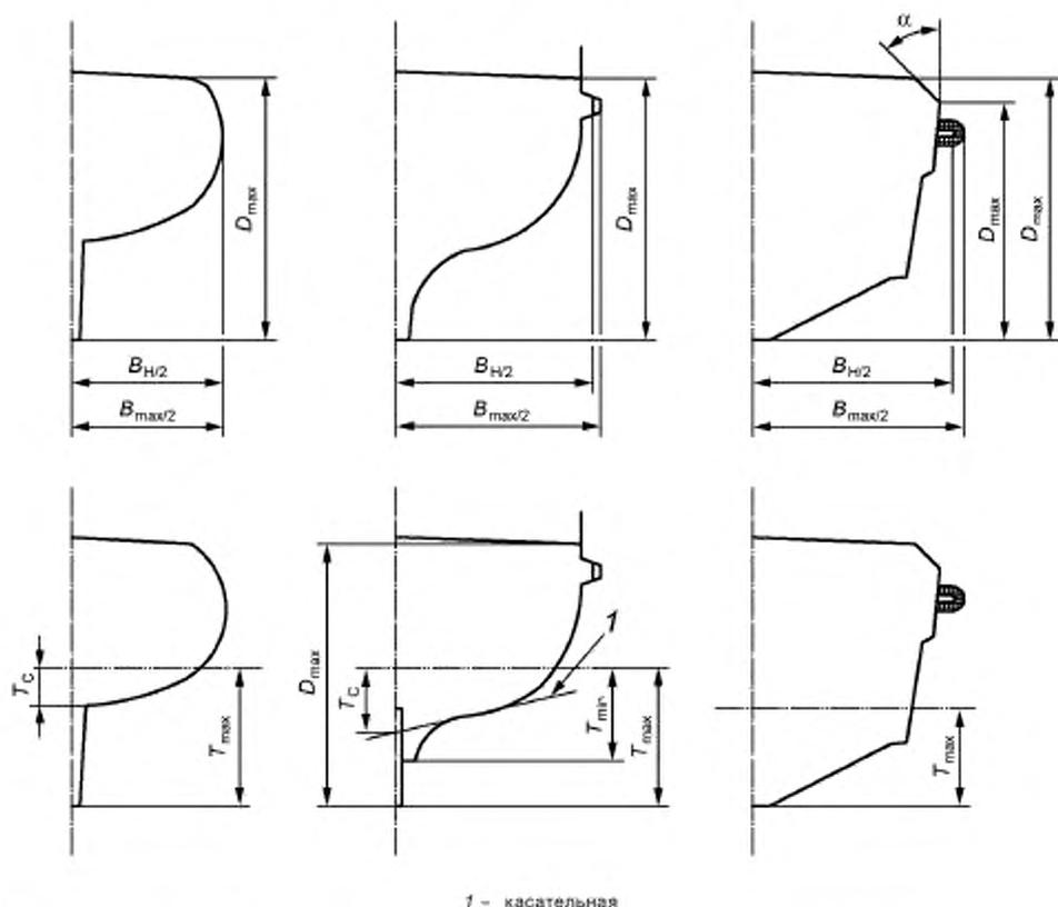
Примечание — Верхнее положение  $D_{\max}$  зависит от угла наклона поверхности слома соединения корпуса/палубы и действительной палубы. При  $\alpha \geq 45^\circ$  применяется нижнее положение. Если  $\alpha < 45^\circ$ , применяется верхнее положение.
