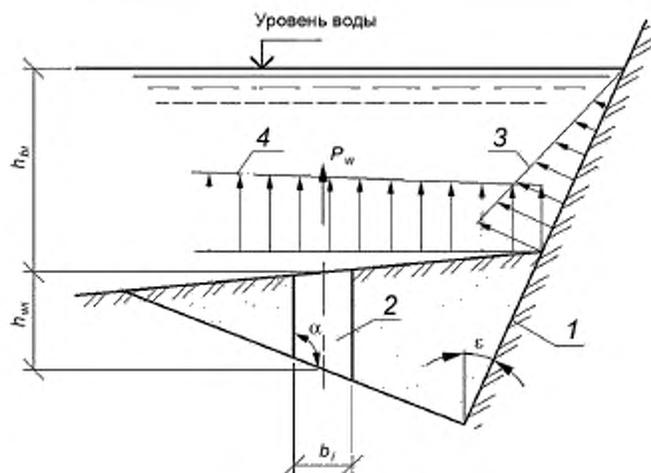
1 — расчетная поверхность; 2 — вертикальный элемент призмы вывора; 3 — эпюра сейсмического давления воды на поверхность стены, контактирующей с водой; 4 — эпюра сейсмического давления воды на поверхность грунта
