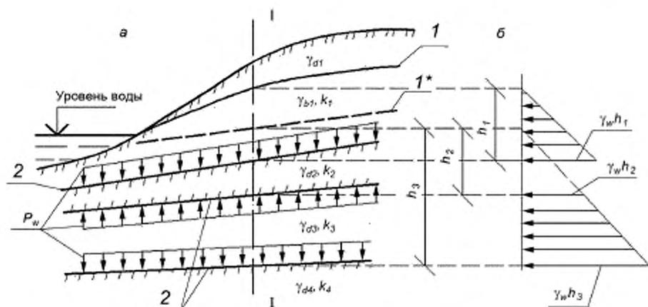
а — Расчетная схема; б — Эюра давления воды в сечении I—I
