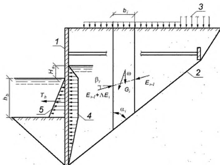
1 — набережная, 2 — возможная поверхность сдвига, 3 — нагрузка на поверхности грунта, 4 — давление фильтрующей воды,
