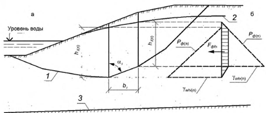
а — Расчетная схема; б — Эпюры давления воды на правую  $P_{\phi(n)}$  и левую  $P_{\phi(n)}$  грани элемента и результирующая горизонтальных сил от давления воды
