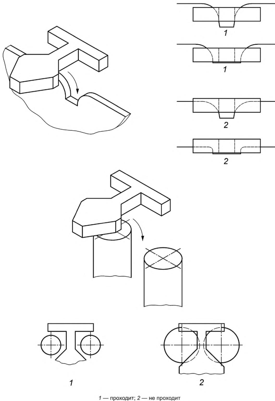
Рисунок D.3 — Способ применения части шаблона «В»
