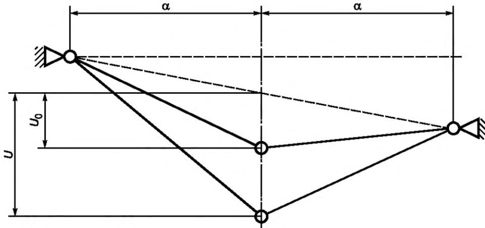
$U_0$  — статический начальный провес несущего троса, состоящий из собственной массы несущего троса и массы бегунка ( $G_c + G_r$ ), м;  $u$  — динамический провес несущего троса под воздействием качающейся массы ( $G_c + G_r + G_n$ ), м, где
