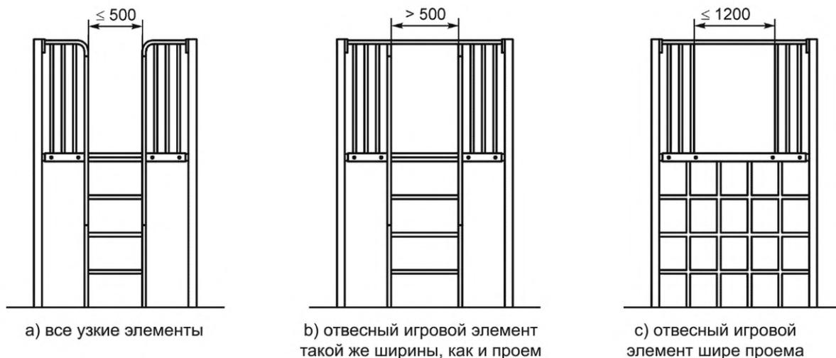
Рисунок 10 — Входные и выходные проемы в ограждениях для отвесных игровых элементов
