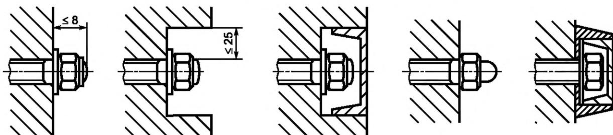
Рисунок 11 — Примеры защиты гаек и болтов
