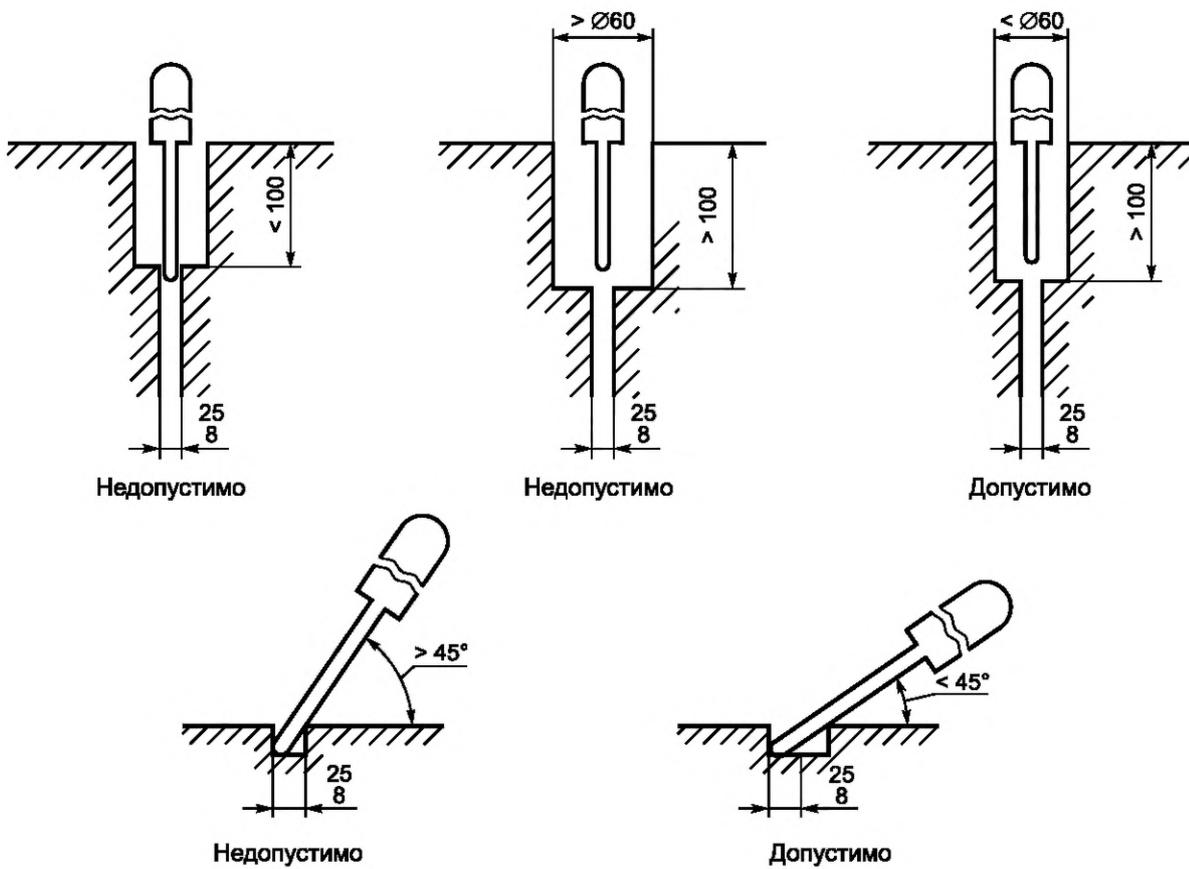
Рисунок D.12 — Возможность прохождения стержня-пальца
