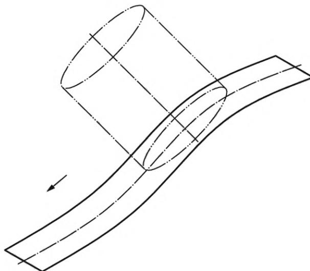
Рисунок 15 — Определение свободного пространства; пример спуска
