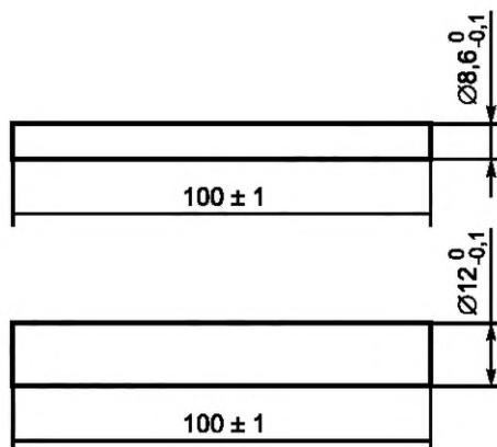
Рисунок D.13 — Испытательные стержни для звеньев цепи
