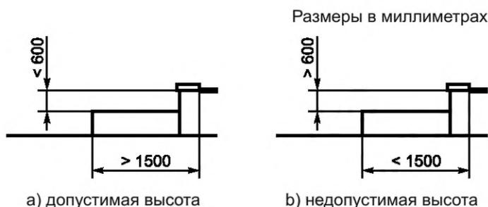
Рисунок 26 — Допустимая и недопустимая высоты прыгательной поверхности
