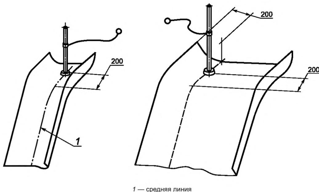
Рисунок D.8 — Расположение испытательного устройства на горках
