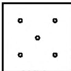
Рисунок 3 — Схема расположения точек измерения твердости материала рукава
