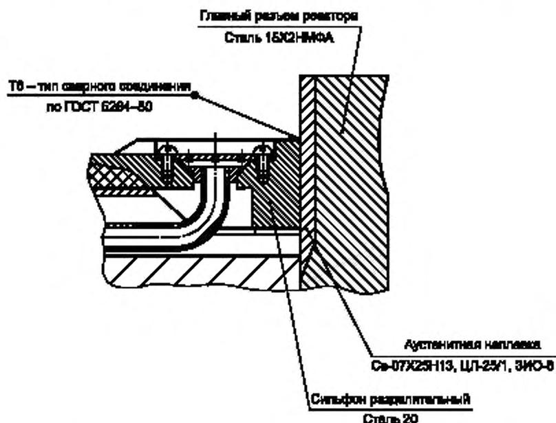
Рисунок 2 — Приварка сильфона к корпусу реактора
