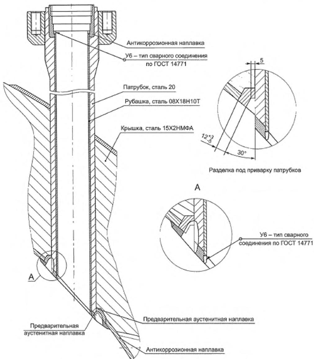
Рисунок 1 — Крышка корпуса реактора в районе приварки патрубка
