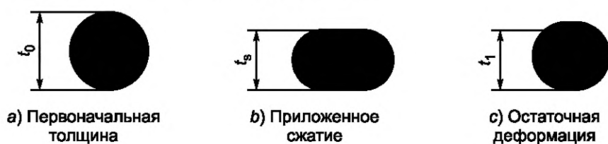
Рисунок 10 — Остаточная деформация при сжатии уплотнительного кольца
