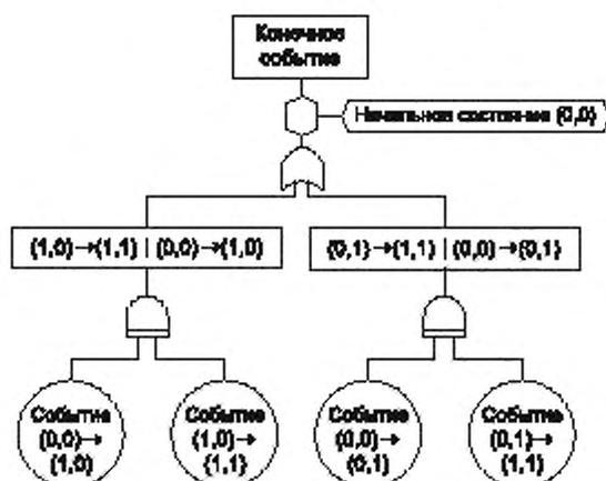
Рисунок 14 — FT неповторяемого конечного события для начального состояния (0,0)
