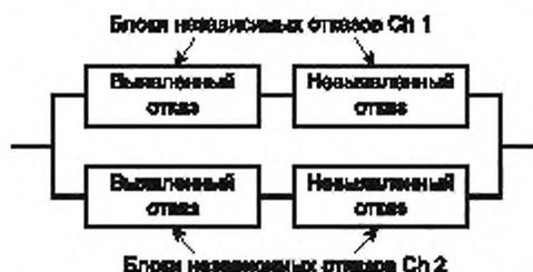
Рисунок 21 — RBD независимых блоков Ch 1 и Ch 2
