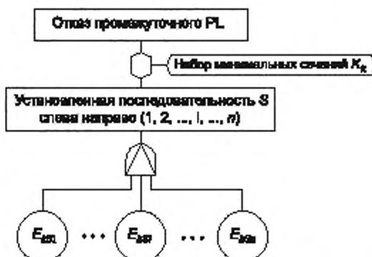
Рисунок 13 — FT для отказа промежуточного уровня защиты в соответствии с логикой последовательных отказов
