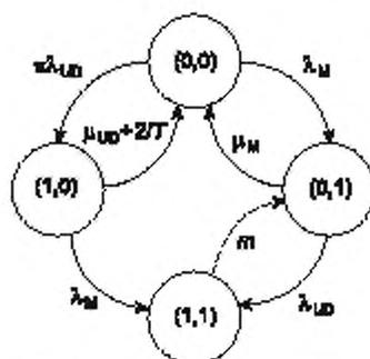
Рисунок 17 — Модель состояний для выявленного состояния  $(0,1)$
