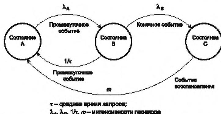
Рисунок 8 — Переходы, приводящие к восстановлению конечного состояния
