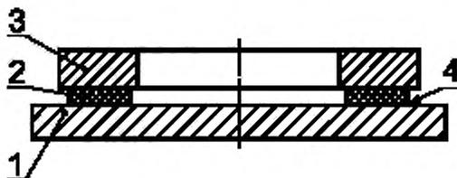
1 — поверочная плита по ГОСТ 10905 не ниже 2-го класса точности, 2 — фрикционная накладка; 3 — нажимное кольцо из стали по ГОСТ 1050, твердость НРС, 57—63; 4 — зона контроля отклонений от плоскостности (по всей длине окружности)
