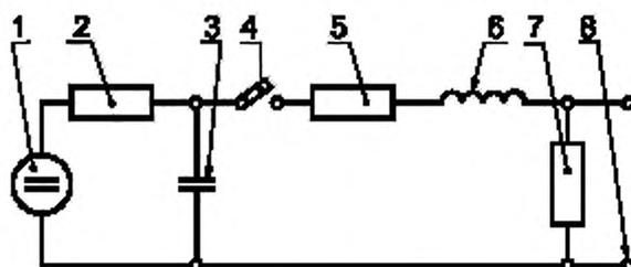
1 — источник высокого напряжения; 2 — зарядный резистор; 3 — зарядный конденсатор; 4 — коммутационный ключ; 5 — резистор цепи формирования длительности импульса, определяющий внутреннее сопротивление ИГ; 6 — индуктивность цепи формирования длительности фронта импульса; 7 — резистор цепи формирования длительности импульса; 8 — к испытуемой цепи ТС АС
