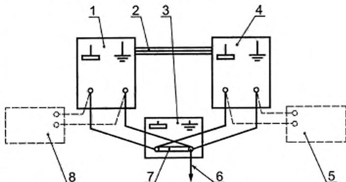
Для случая, когда каждая стойка изделия снабжена замкнутыми между собой в пределах стойки цепями защитного и сигнального заземления, а вне стоек эти цепи соединены с общим контуром или специальной магистралью защитного заземления (вариант 2), испытательные посылки тока поочередно подают между зажимами защитного заземления каждой пары стоек в соответствии с рисунком 4, если между испытуемыми стойками имеются линии связи.
