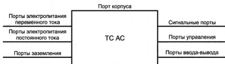
Рисунок 1 — Примеры портов ТС АС
