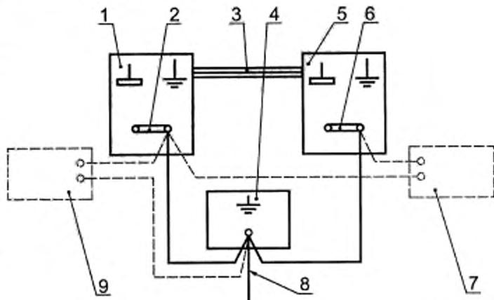
Если монтаж системы заземления выполнен таким образом, что имеется опорный узел заземления всех стоек, то испытательные посылки тока подаются также между этим узлом и зажимами защитного заземления стоек, отстоящих от узла не далее 3 м (см. рисунок 4).
