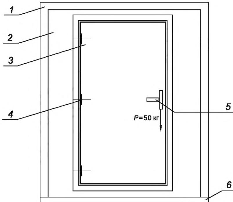
1 — рама; 2 — щит выгородки; 3 — дверь; 4 — петля двери; 5 — ручка; 6 — плита испытательного стенда
