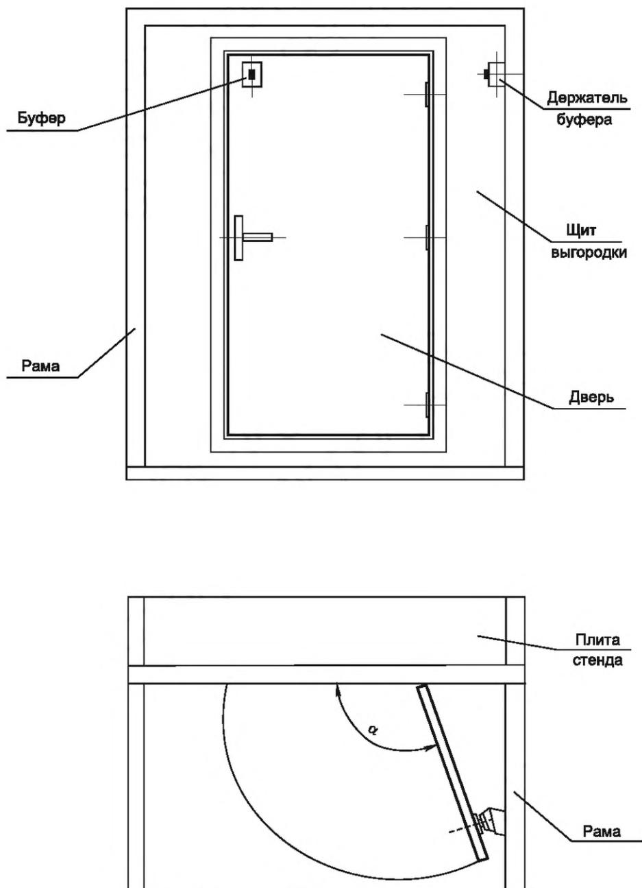
Рисунок А.1 — Типовая схема установки образца одностворчатой распашной двери на испытательном стенде
