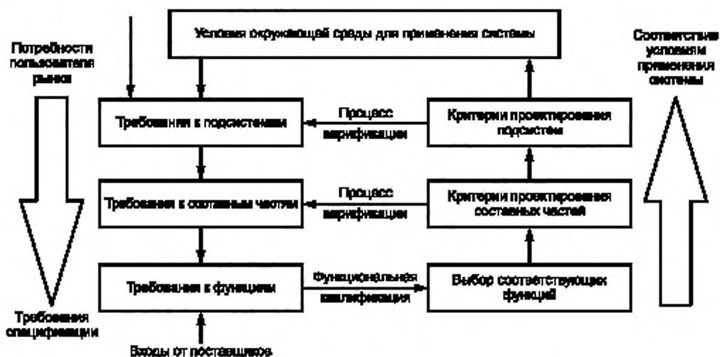
Рисунок С.1 — Процесс определения требований среды
