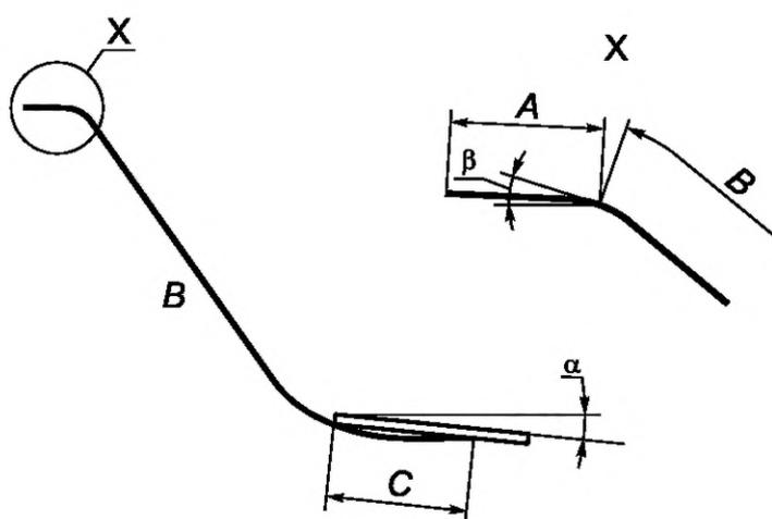
A — стартовый участок, измеренный вдоль поверхности горки; B — участок скольжения, измеренный вдоль поверхности горки;
