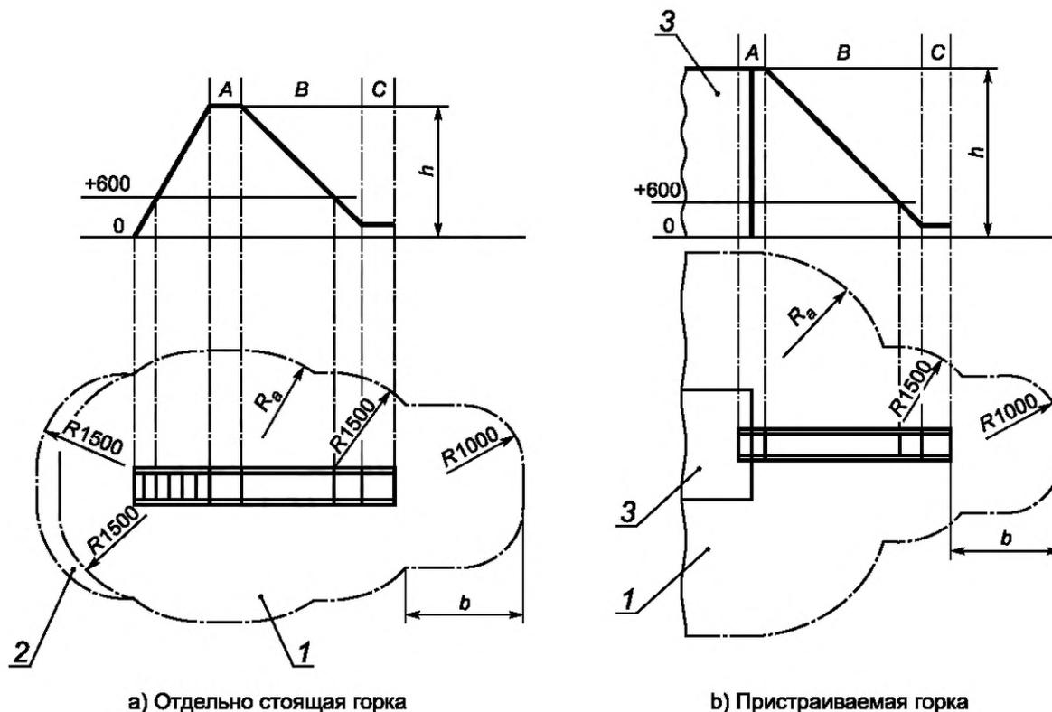
*A* — стартовый участок; *B* — участок скольжения; *C* — конечный участок; *1* — зона приземления; *2* — поверхность зоны приземления, не подлежащая испытаниям в соответствии с требованиями ГОСТ 34614.1—2019 (пункт 4.2.8.5.3); *3* — игровая конструкция; *h* — высота свободного падения;  $R_a$  — размер пространства падения в зависимости от высоты свободного падения; *b* — длина участка скольжения в зависимости от типа конечного участка
