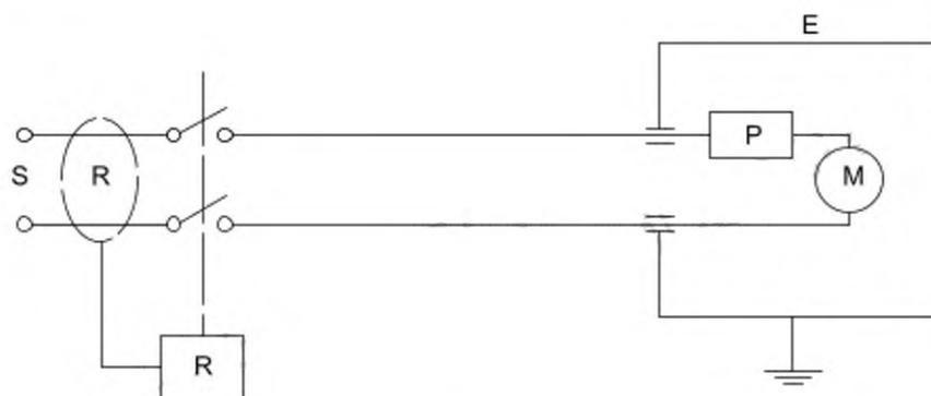
S — питание; E — кожух электродвигателя; R — устройство защитного отключения ( $I_{\Delta n} = 30 \text{ mA}$ ) с автоматическим выключателем или без него; P — защитное устройство (внешнее или внутреннее); M — электродвигатель
