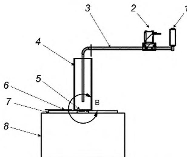
1 — баллон хладагента с клапаном; 2 — клапан; 3 — распылитель; 4 — стеклянный цилиндр;
