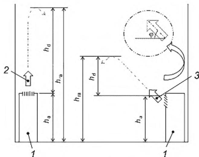
1 — прибор; 2 — направление воздушного потока: вверх (вертикально под углом  $\varphi = 90^\circ$ );
