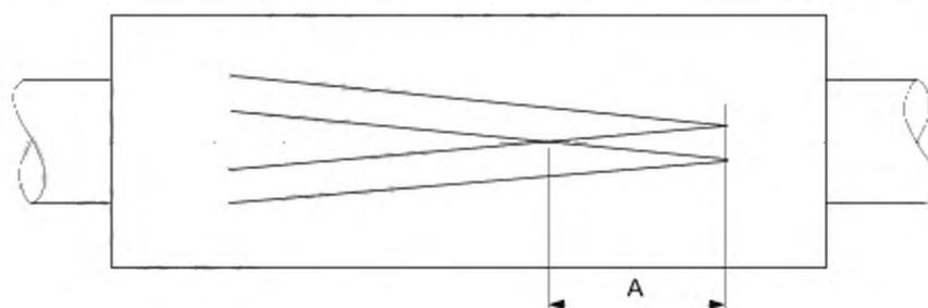
Рисунок GG.4 — Измерение амплитуды вибрации
