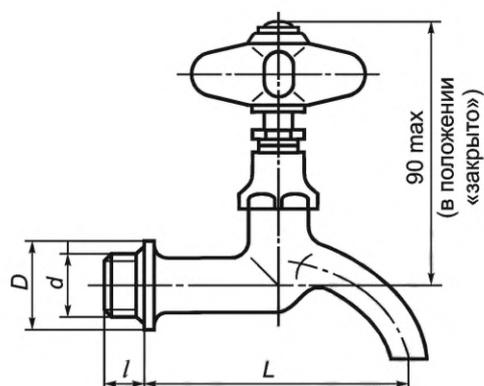
Рисунок 27 — Кран водоразборный настенный. Тип КрН
