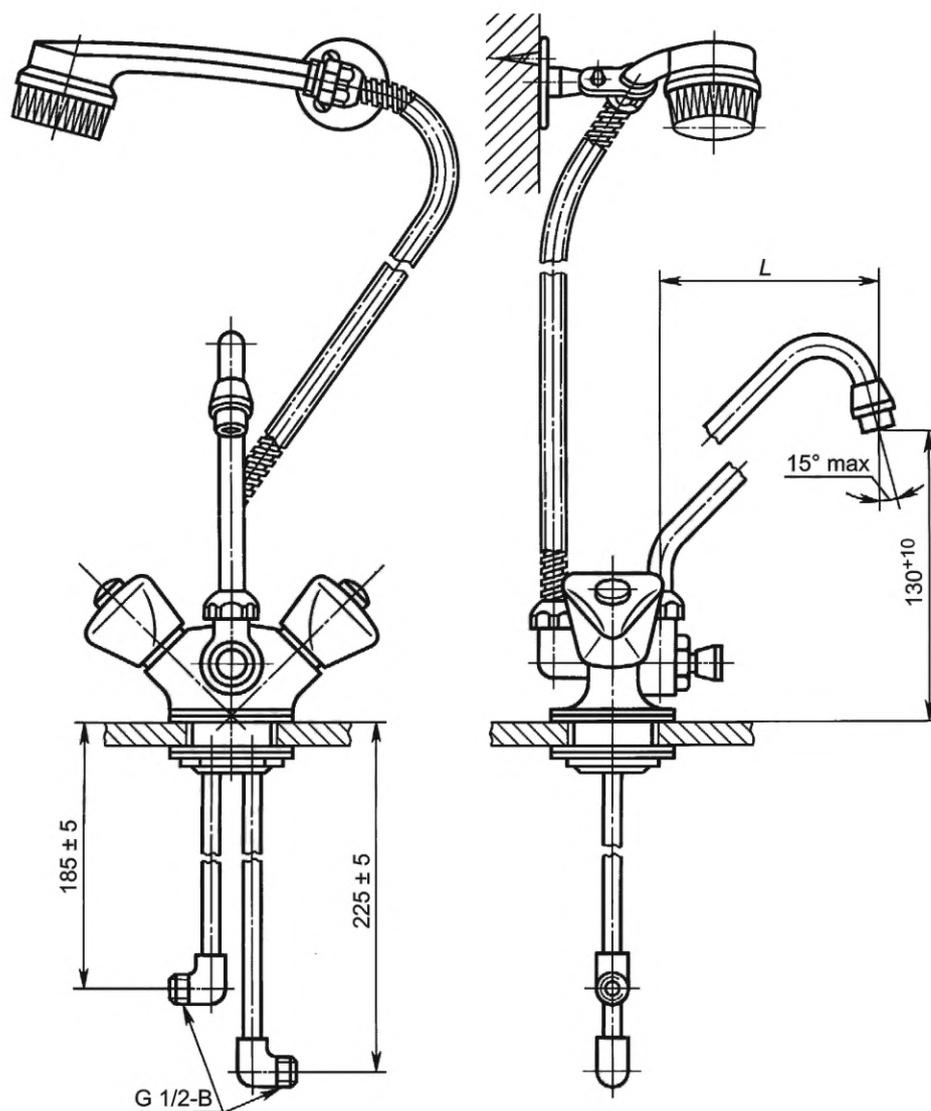
Рисунок 9 — Смеситель для мойки двухрукояточный центральный наворотный со щеткой с настенным креплением, излив с аэратором. Тип См-МДЦБЦБА
