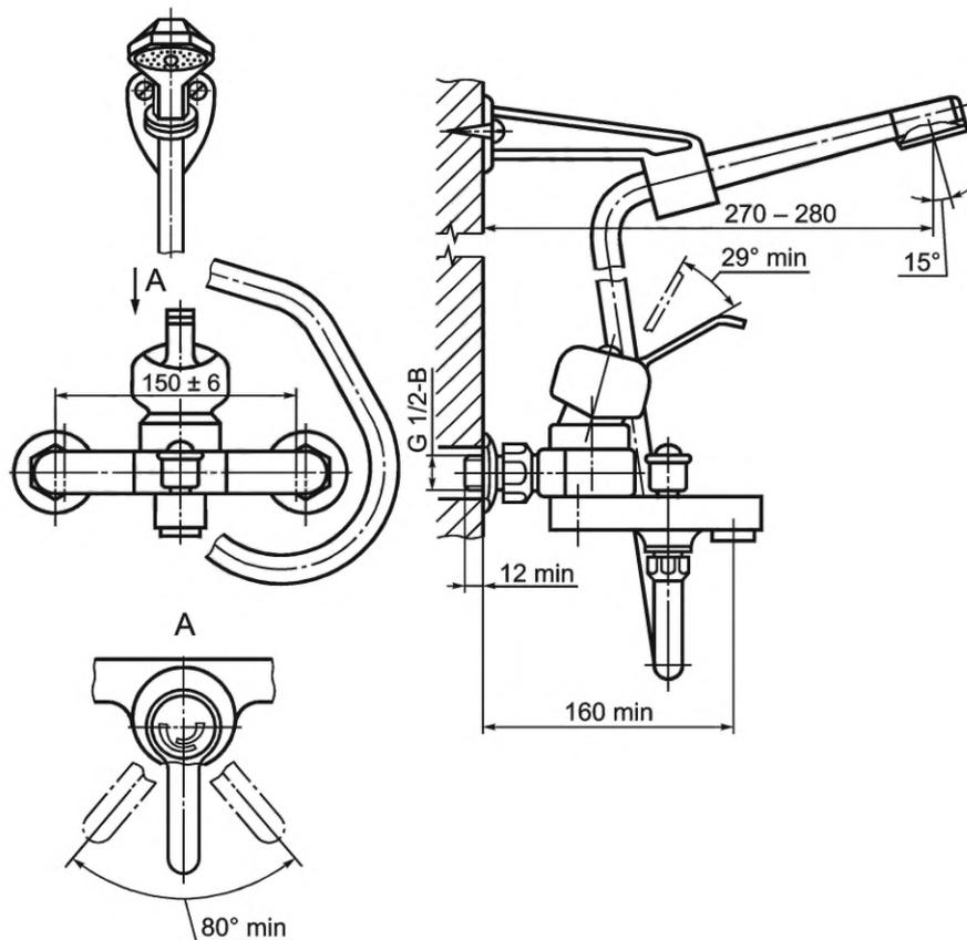
Рисунок 15 — Смеситель для ванны однорукояточный с подводками в отдельных отверстиях настенный с душевой сеткой на гибком шланге, излив с аэратором.
