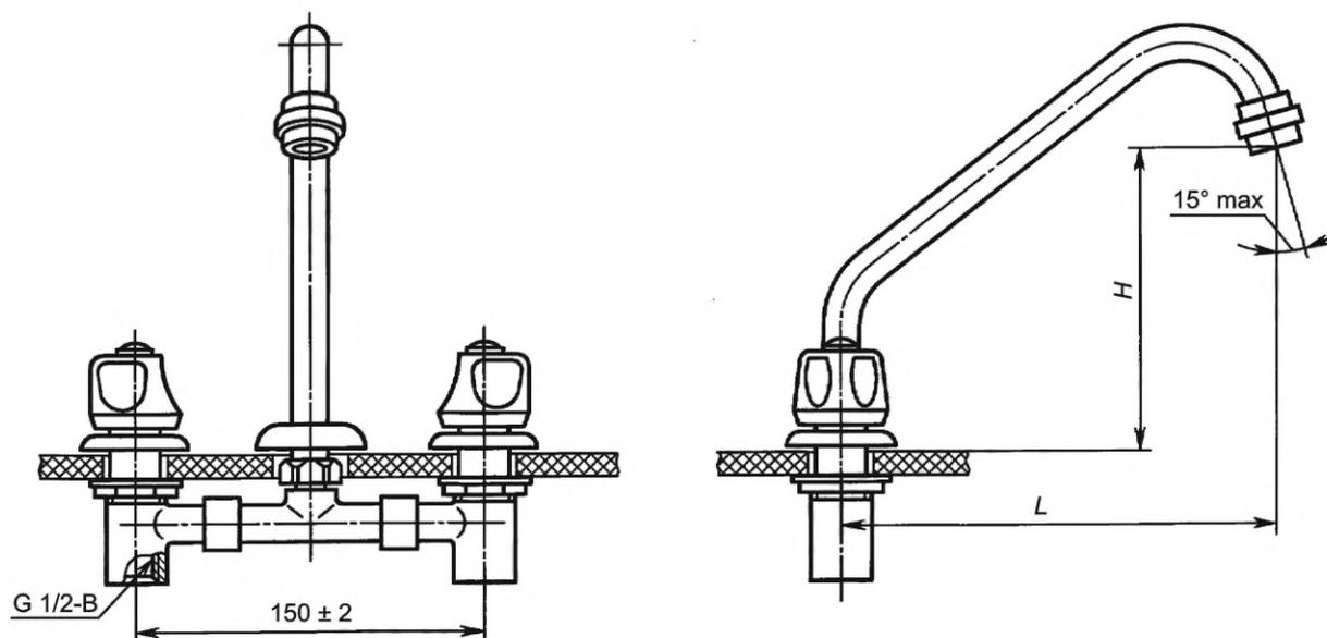
Рисунок 6 — Смеситель для умывальника и мойки двухрукоятный с подводками в отдельных отверстиях набортный, излив с аэратором. Типы См-УмДР5А, См-МДР5А
