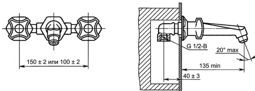
Рисунок 4 — Смеситель для умывальника двухрукоятный с подводками в отдельных отверстиях застенный, излив с аэратором. Тип См-УмДРЗА
