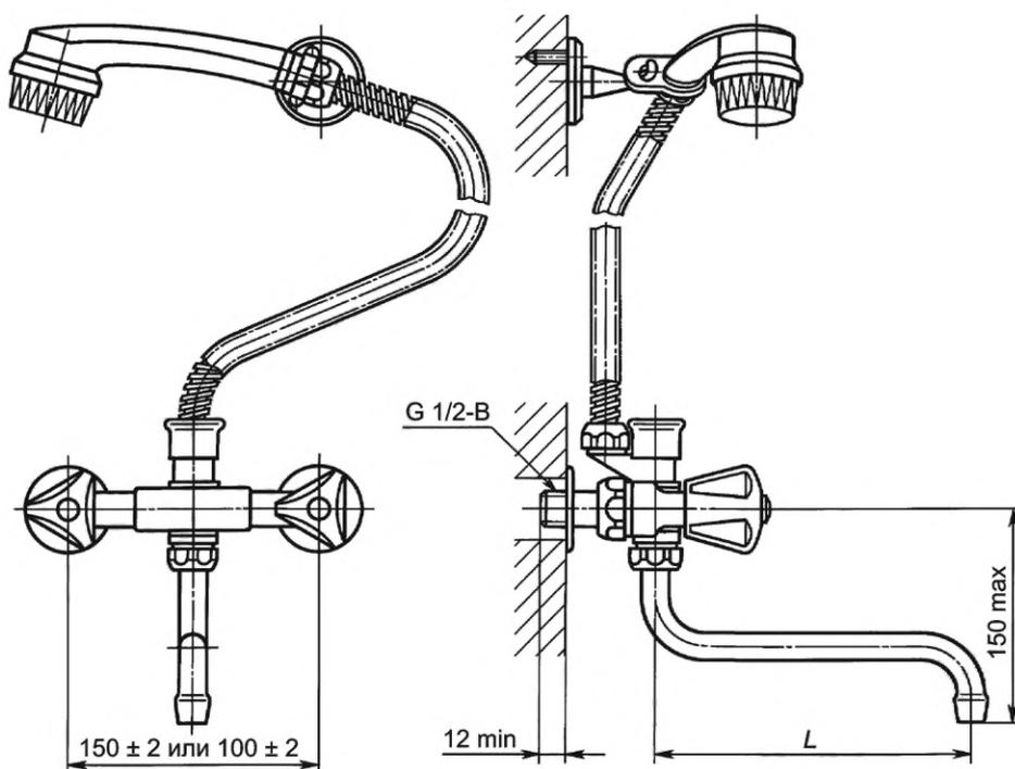
Рисунок 11 — Смеситель для мойки двухрукояточный с подводками в раздельных отверстиях настенный со щеткой с настенным креплением, излив с развальцованным носиком. Тип См-МДРНЩнр
