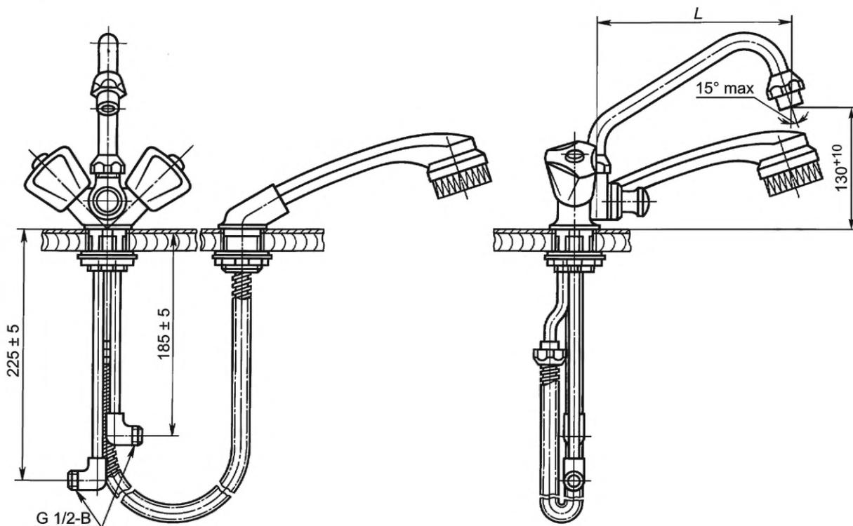
Рисунок 8 — Смеситель для мойки двухрукояточный центральный наборный со щеткой с наборным креплением, излив с аэратором. Тип См-МДЦБЩБА
