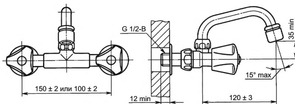
Рисунок 5 — Смеситель для умывальника двухрукоятный с подводками в отдельных отверстиях настенный, излив с аэратором. Тип См-УмДР4А
