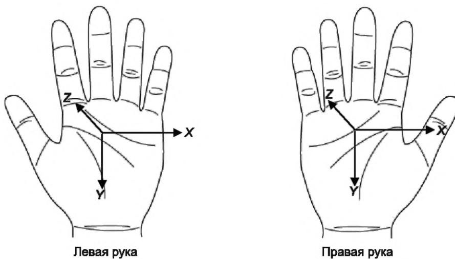
Рисунок 2 — Стандартное положение и система координат ладони.
