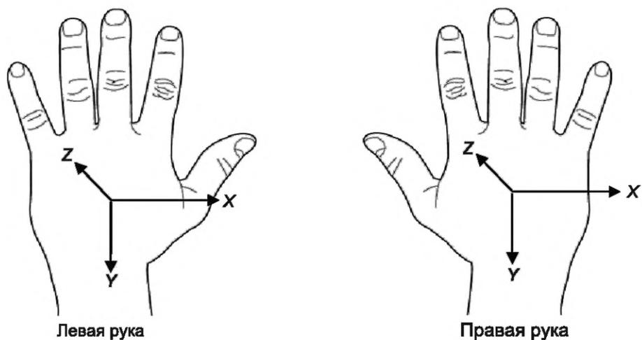
Рисунок 1 — Стандартное положение и система координат тыльной стороны кисти руки.
