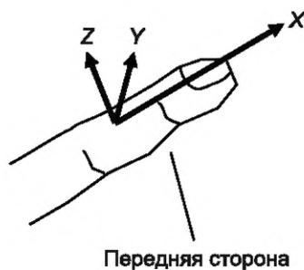
Рисунок 3 — Стандартное положение и система координат пальца.
