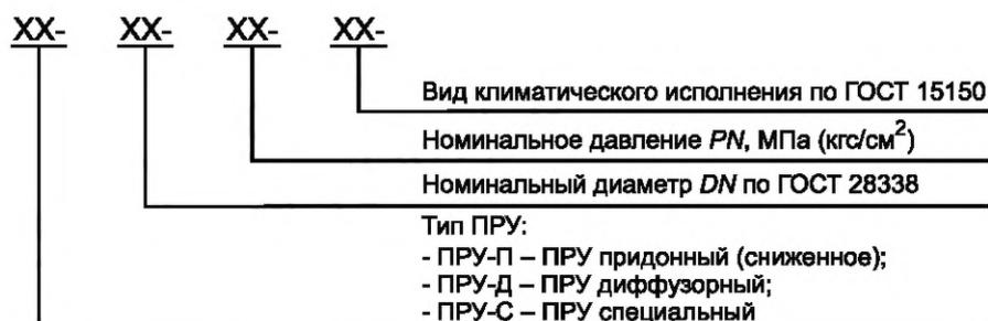
Рисунок 1 — Схема условного обозначения приемо-раздаточного устройства
