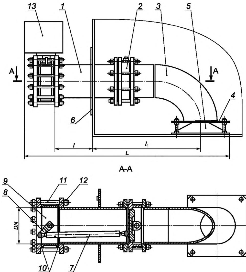
1 — патрубок; 2 — затвор дисковый; 3 — отвод; 4 — зонт; 5 — рассекатель; 6 — лист усиливающий; 7 — тяга; 8 — рычаг; 9 — проводной узел; 10 — прокладка; 11 — шпилька; 12 — гайка; 13 — привод
