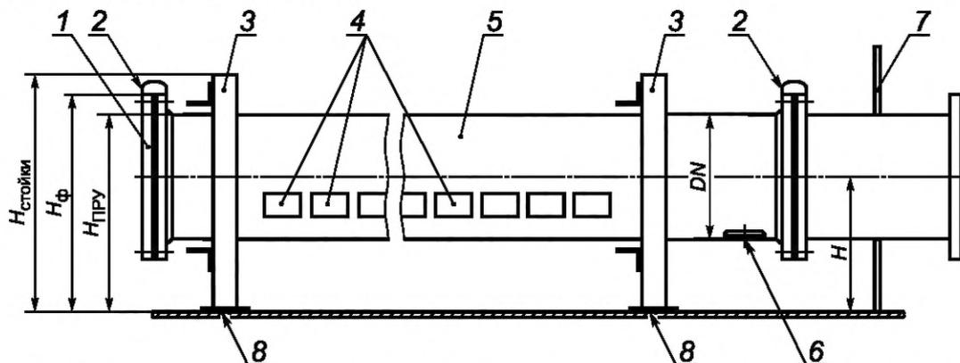
1 — заглушка; 2 — шунтирующая перемычка; 3 — стойка; 4 — технологические отверстия; 5 — обечайка; 6 — сливное отверстие; 7 — стенка резервуара; 8 — накладка на днище
