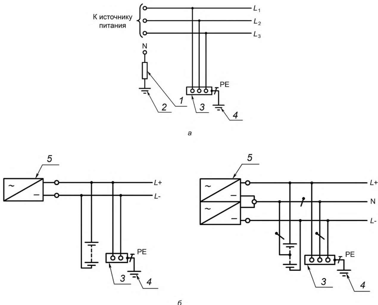
1 — сопротивление заземления нейтрали источника питания (если имеется); 2 — заземлитель; 3 — открытые проводящие части; 4 — заземляющее устройство электрооборудования лифта; 5 — источник питания
