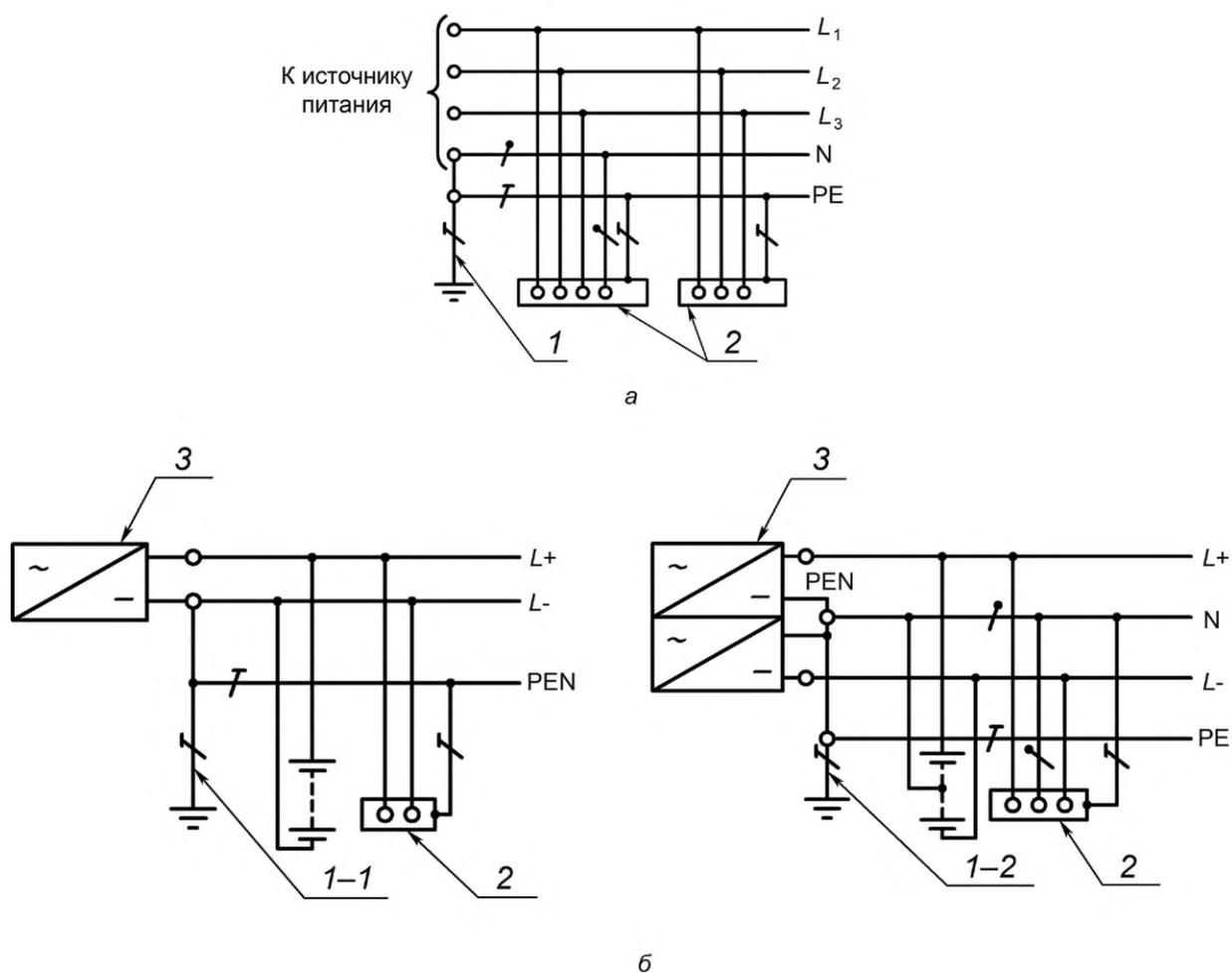
1 — заземлитель нейтрали источника переменного тока; 1—1 — заземлитель вывода источника постоянного тока;
