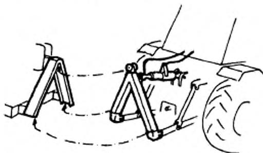
Рисунок 1 — Принцип работы системы с А-образным сцепным устройством
