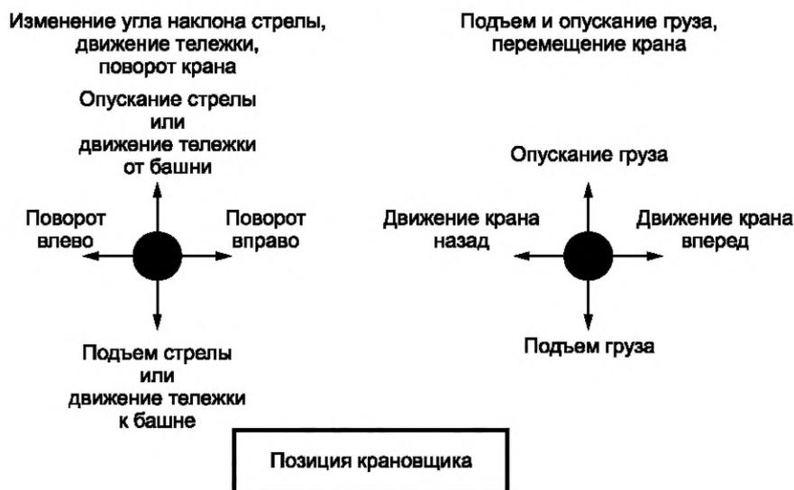
Рисунок 1 — Схема расположения основных органов управления башенным краном
