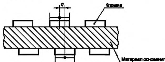
Рисунок 15 — Смещение середины клемм на верхней и нижней стороне платы
