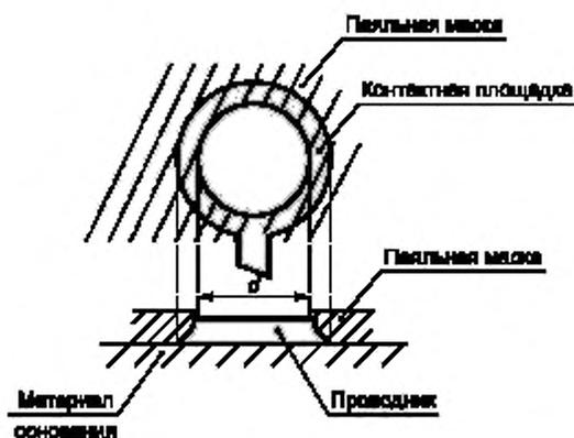
Рисунок 19 — Диаметр контактной площадки ( $d$ ) для корпусов BGA или CSP, сформированной окном в паяльной маске
