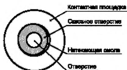
Рисунок 38 б — Горизонтальный микрошлиф
