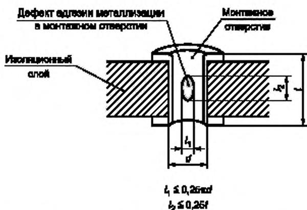
Рисунок 37 — Дефект металлизации монтажного отверстия
