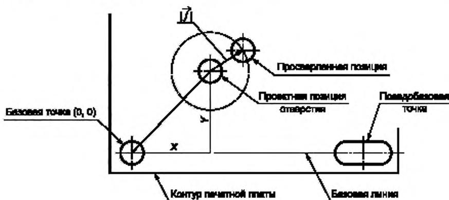
Рисунок 7 — Расположение монтажных отверстий для установки компонентов
