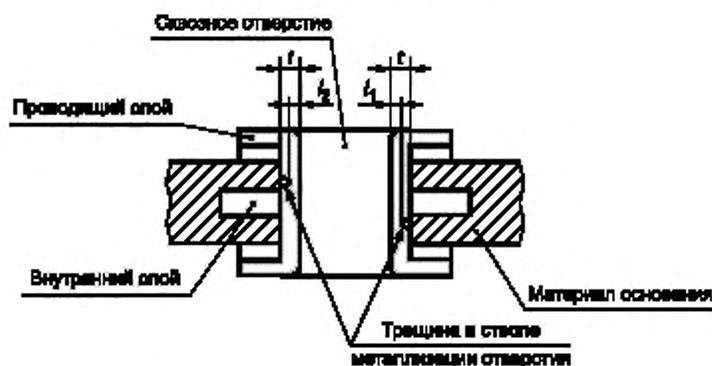
Рисунок 40 — Трещина ствола
