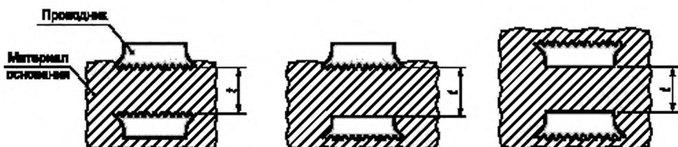
Примечание — Если поверхность медной фольги шероховатая, толщина основного материала — это минимальное расстояние между выступами фольги разных проводников.
