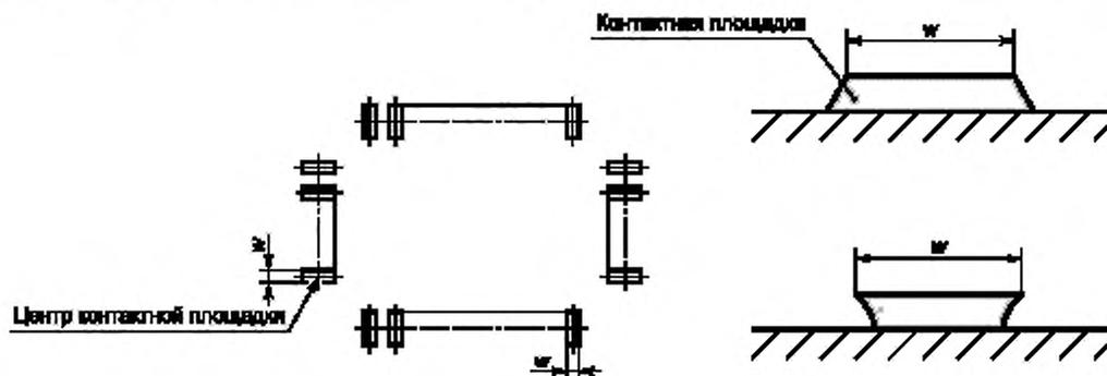
Рисунок 17 — Ширина контактной площадки посадочного места
