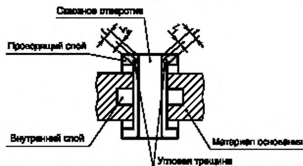
Рисунок 39 — Угловая трещина
