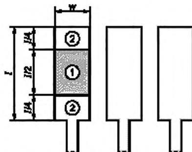
Рисунок 33 — Проверяемые области дефектов печатного контакта
