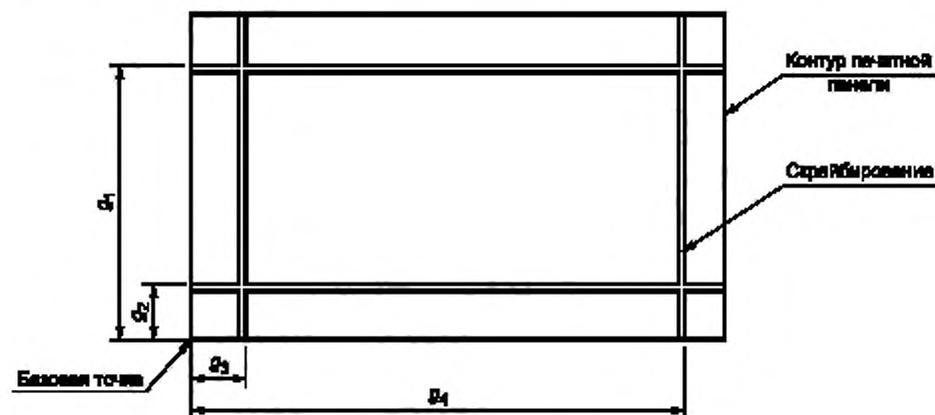
Рисунок 4 — Расстояние от базовой точки до скрайбирования
