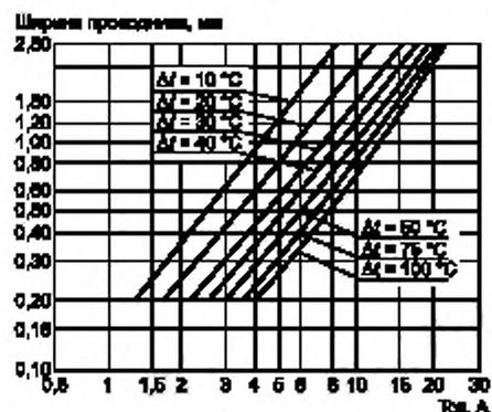
Рисунок 36 — Соотношения между током, шириной проводника, толщиной и ростом температуры
