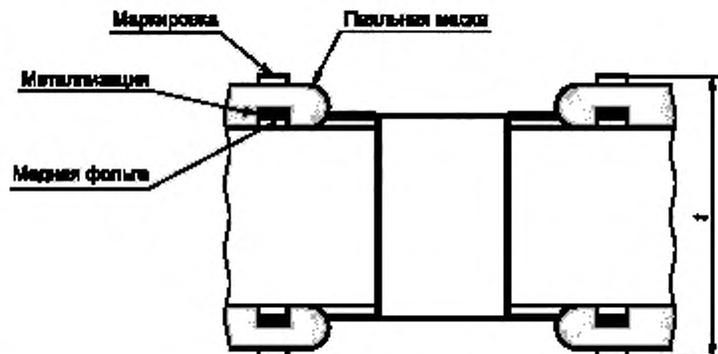
Рисунок 6 — Плата печатная с маркировкой, паяльной маской, медной фольгой и металлизацией
