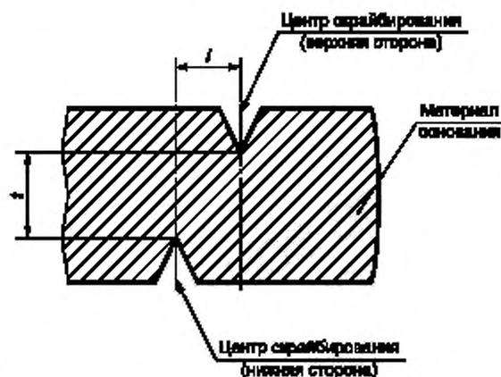
Рисунок 5 — Допустимое отклонение позиционного смещения скрайбирования на верхней и нижней поверхностях
