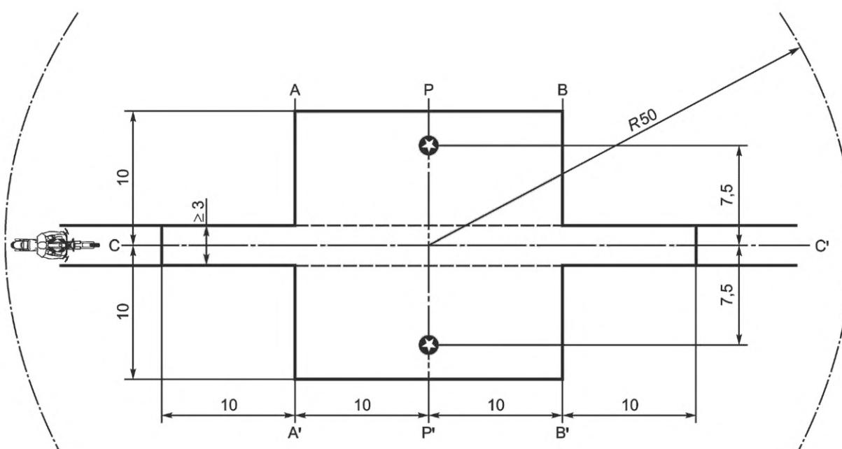
— минимальная площадь со специальным испытательным покрытием, т.е. испытательная площадка;
