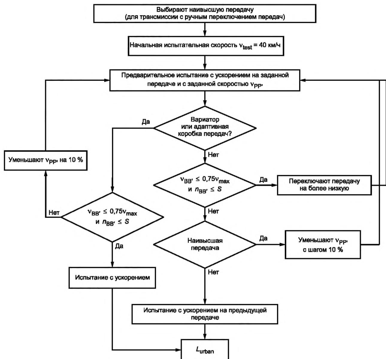
Рисунок D.1 — Блок-схема метода испытаний для транспортных средств категорий L3 с PMR ≤ 25
