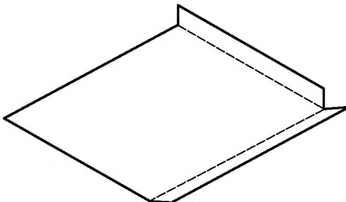
Рисунок 3 — Прокладочный лист с двумя выступами.
