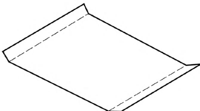
Рисунок 4 — Прокладочный лист с двумя выступами.
