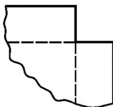
**а** – зауголок со срезом кромок под углом 90°
