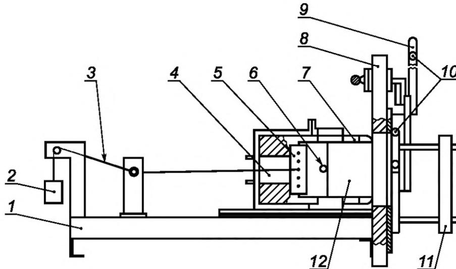
1 — платформа; 2 — груз; 3 — нити; 4 — датчик теплового потока; 5 — зажим; 6 — термоэлектрический преобразователь; 7 — держатель; 8 — экран; 9 — заслонка; 10 — система охлаждения; 11 — радиационная панель; 12 — образец
