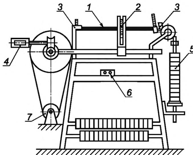
1 — образец; 2 — абразив; 3 — зажим; 4 — счетчик;
