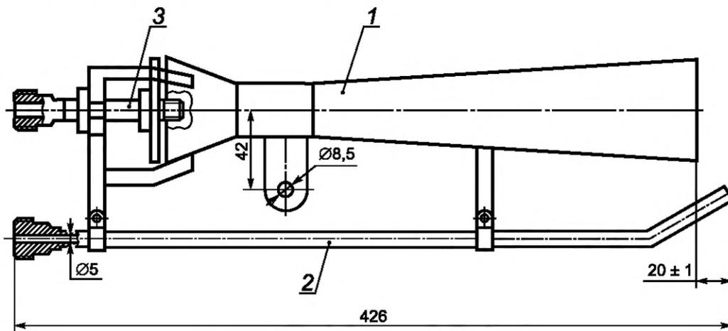
1 — диффузор; 2 — трубка поджига; 3 — сопло
