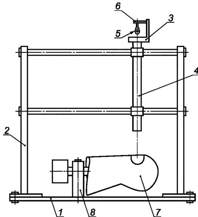
1 — станина; 2 — стойки; 3 — держатель; 4 — направляющая труба; 5 — ударник;
