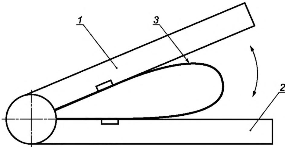
1 — прижимная пластина; 2 — контактирующая пластина; 3 — образец
