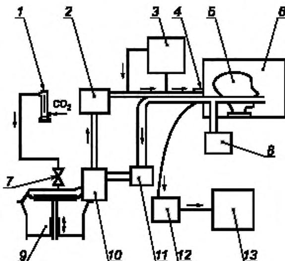
1 — дозатор диоксида углерода; 2 — термостат с увлажнителем; 3 — анализатор диоксида углерода; 4 — датчики температуры и влажности; 5 — «Шеффилдский» муляж головы человека; 6 — климатическая камера; 7 — односторонний клапан; 8 — прибор для измерения сопротивления дыханию; 9 — насос «искусственные легкие»; 10 — клапанная коробка с клапанами вдоха и выдоха; 11 — поглотитель диоксида углерода; 12 — насос для отбора проб; 13 — анализатор диоксида углерода
