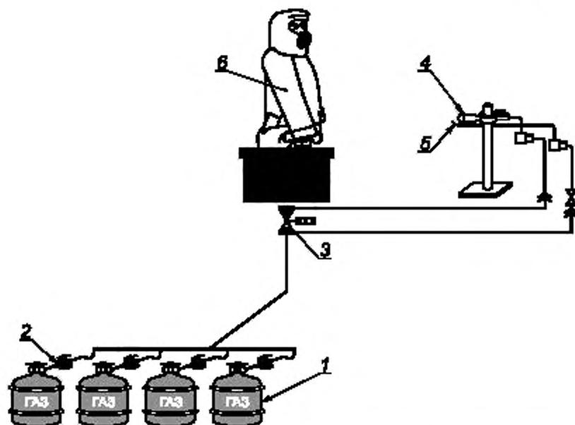
1 — баллоны газовые, 2 — редуктор; 3 — клапан электромагнитный; 4 — горелка газовая;
