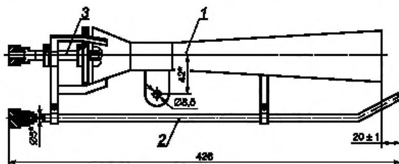
1 — диффузор; 2 — трубка поджига; 3 — сопло
