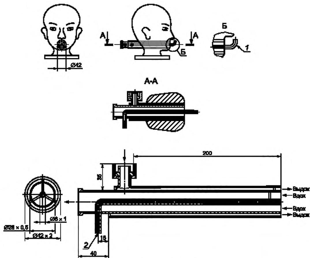
1 — патрубков для измерения сопротивления дыхания; 2 — патрубков для измерения CO<sub>2</sub>
