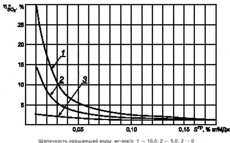
Рисунок А.2 — Степень улавливания оксидов серы в мокрых золоуловителях в зависимости от приведенной сернистости топлива и щелочности орошающей воды
