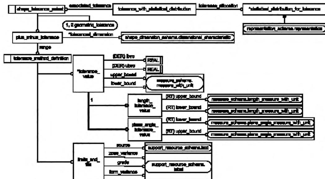
Рисунок D.8 — EXPRESS-G диаграмма схемы `shape_tolerance_schema`
