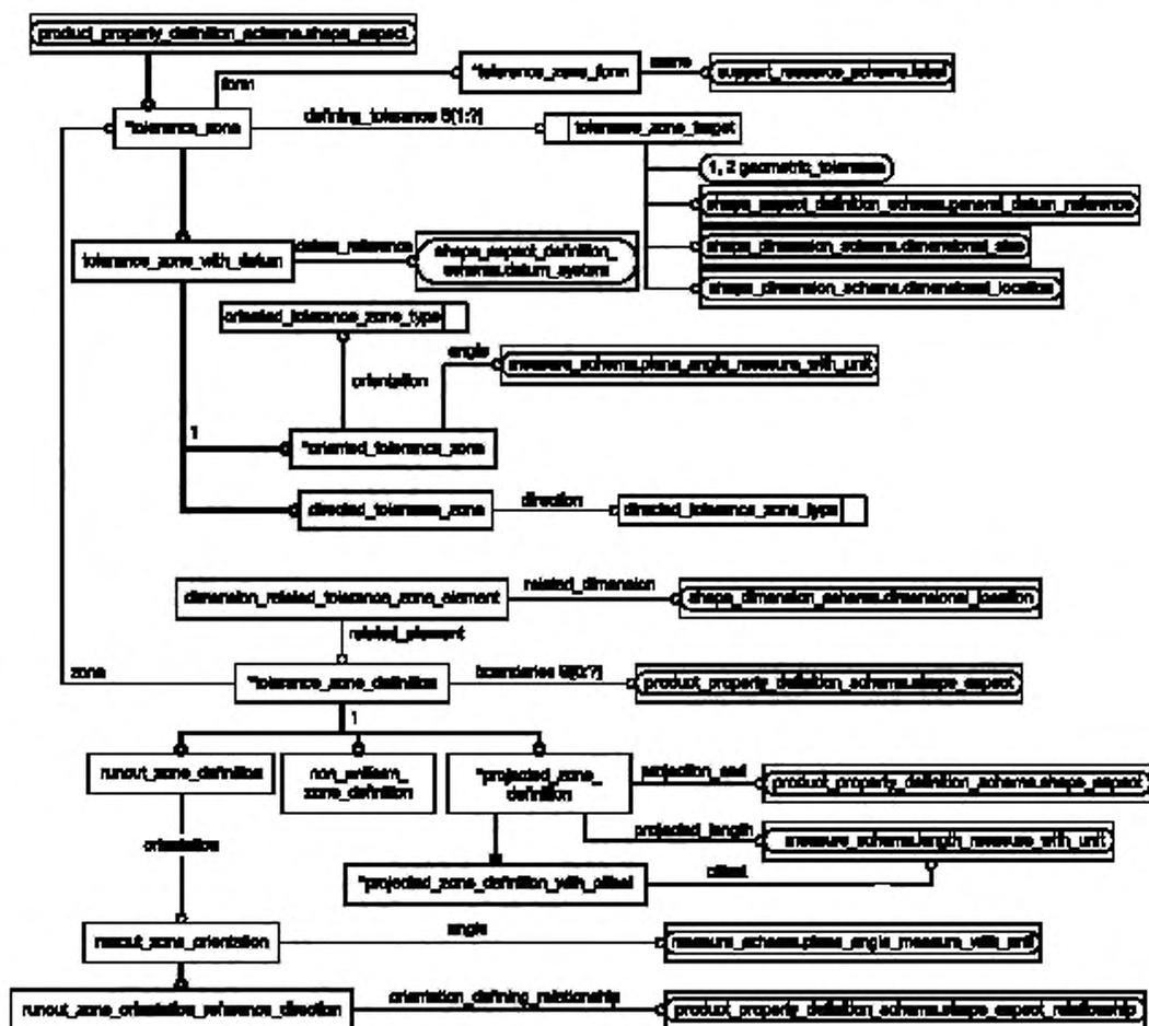
Рисунок D.7 — EXPRESS-G диаграмма схемы shape\_tolerance\_schema
