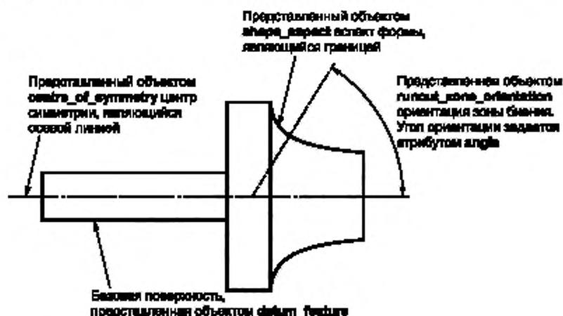
Рисунок 14 — Определение поля допуска биения
