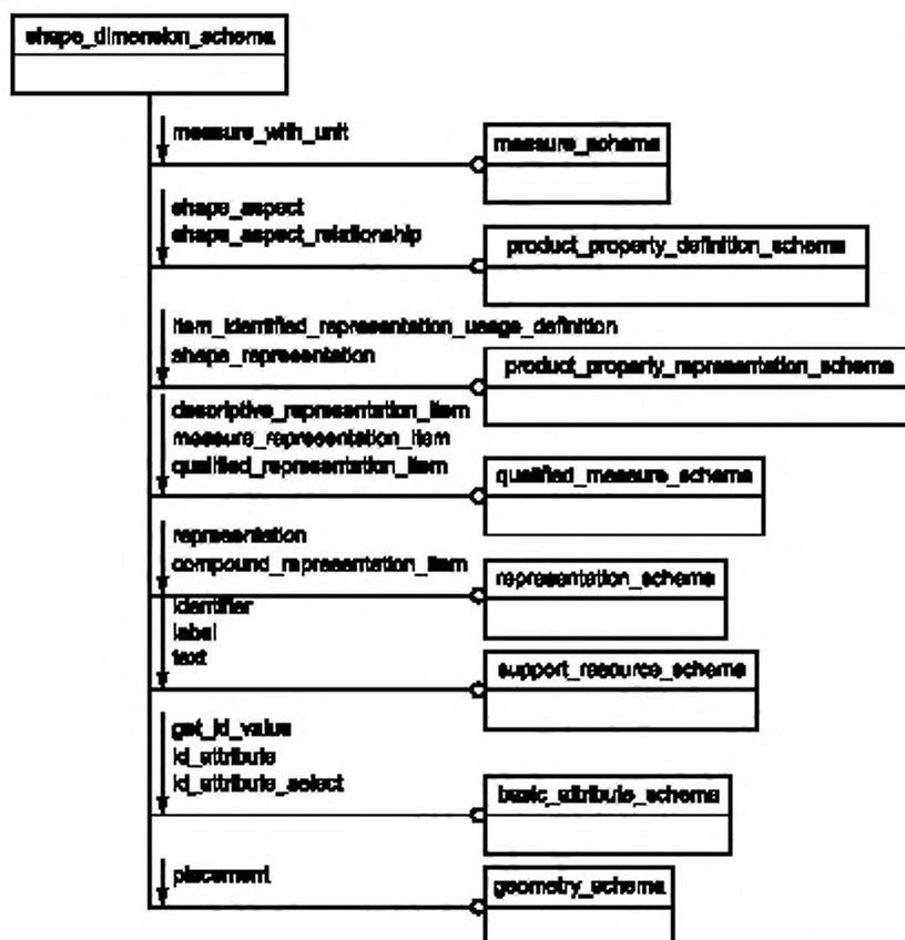
Рисунок D.3 — EXPRESS-G диаграмма схемы `shape_dimension_schema`
