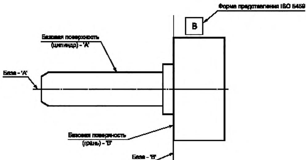
Рисунок 4 — Пример базы и базовой поверхности
