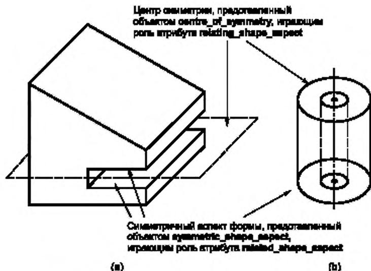
Рисунок 2 — Симметричный аспект формы и центр симметрии
