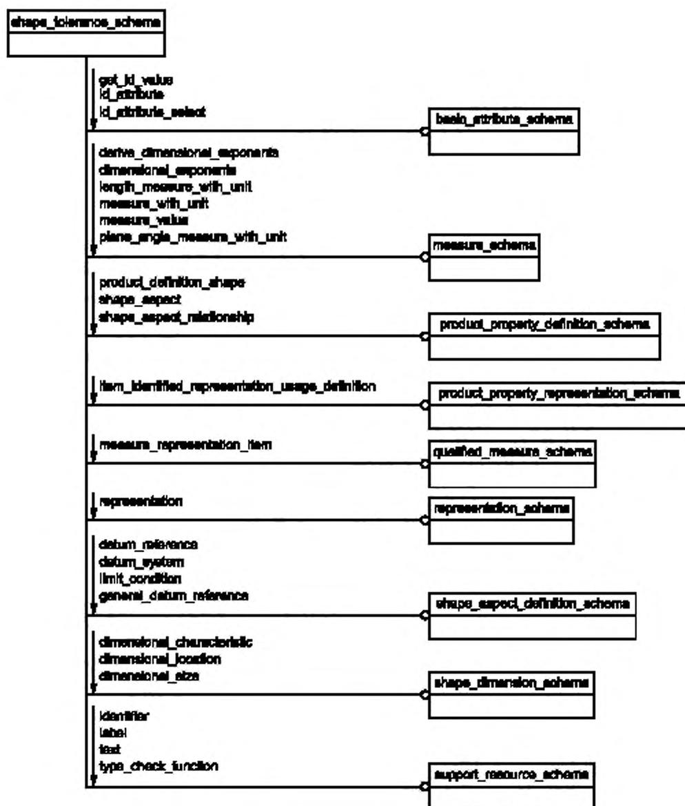
Рисунок D.5 — EXPRESS-G диаграмма схемы `shape_tolerance_schema`
