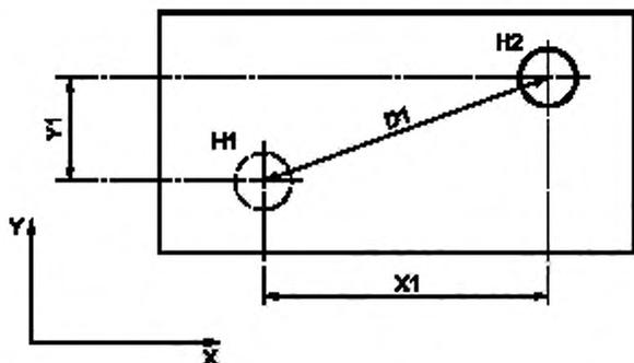
Рисунок 13 — Установочный и присоединительный размер с измеряемым отрезком
