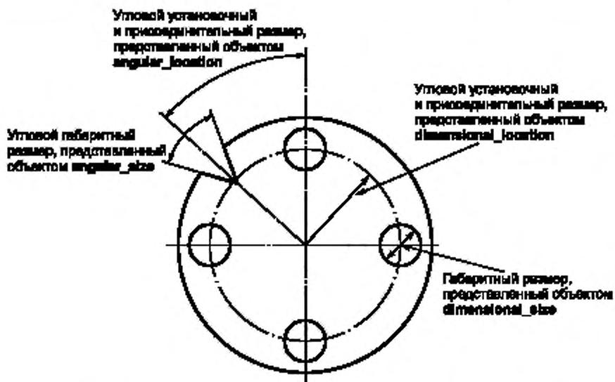
Рисунок 12 — Установочный и присоединительный размер и габаритный размер
