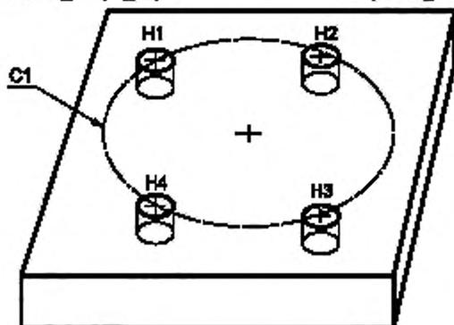
Рисунок 8 — Симметричный аспект формы и составной аспект формы
