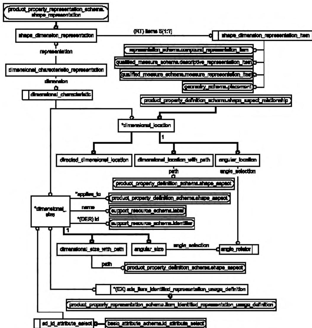
Рисунок D.4 — EXPRESS-G диаграмма схемы shape\_dimension\_schema
