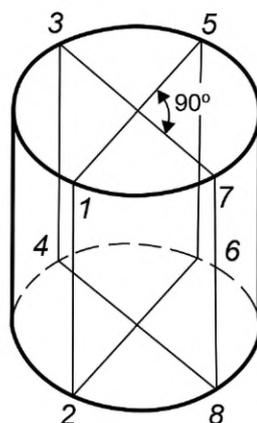
Рисунок 2 — Обозначение частей цилиндрической упаковки
