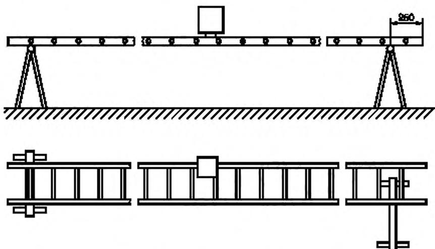
Рисунок 3 — Схема установки или подвески контрольного груза
