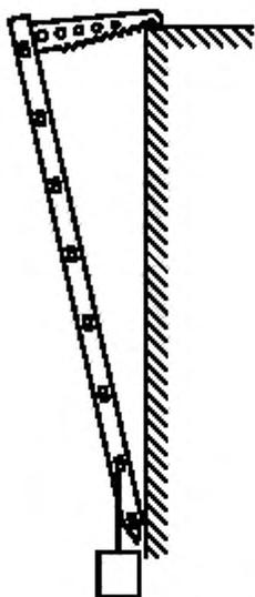
Рисунок 11 — Схема испытания крюка штурмовой лестницы на прочность
