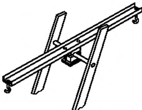
Рисунок 7 — Приспособление для испытания ступеньки на кручение
