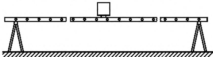
Рисунок 1 — Схема установки лестницы на опоры
