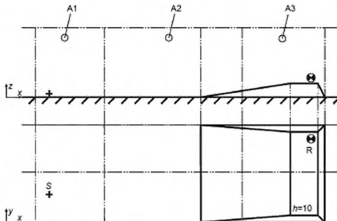
А1 — область пористого грунта; А2 — область разнородного грунта; А3 — область звукоотражающего грунта;
