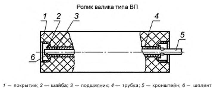
Рисунок А.3 — Ролик валика типа ВП
