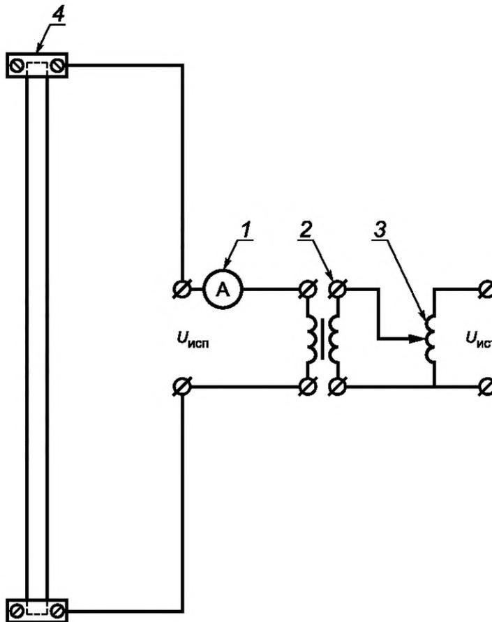
1 — амперметр; 2 — нагрузочный трансформатор; 3 — автотрансформатор; 4 — испытательная рамка
